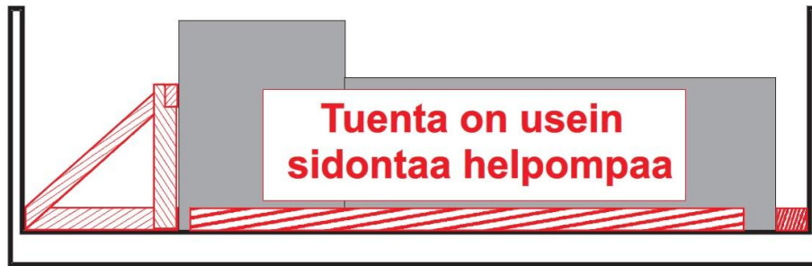
Kuva 4. Esimerkkikuva kuorman tuennasta. (Kuormansidonnan käsikirja 2004, 15.)
