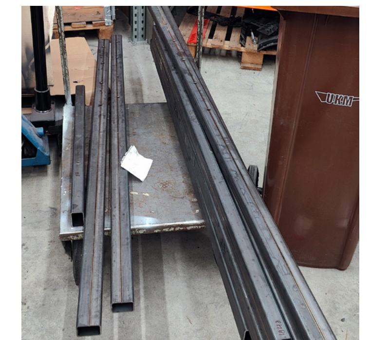
Kuva 28. Käsillä poratut tolppaosien kiinnitysreiät
