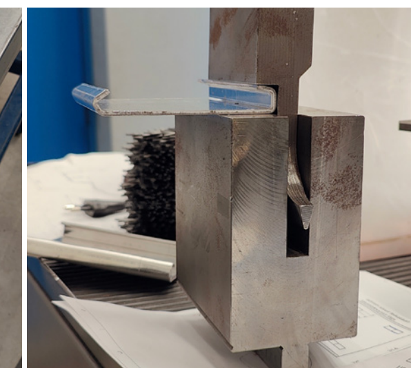
Kuva 24. Taustalevyn U-profiilin työstö
