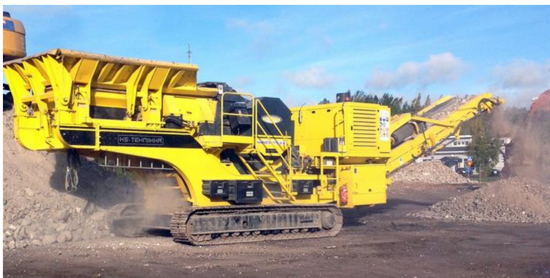
Kuva 6. Betonin murskausta työmaalla leukamurskaimella. (Gles, leukamurskain)
