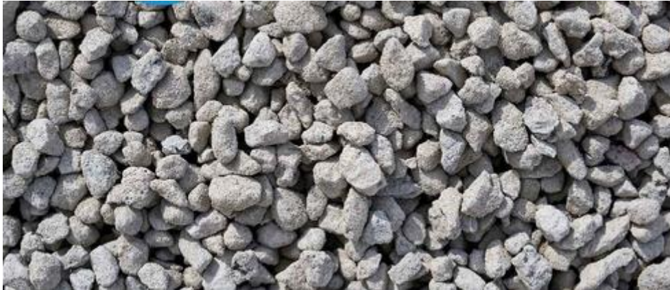
Kuva 7. 0/45 betonikiviainesta. Kuva: Rudus
