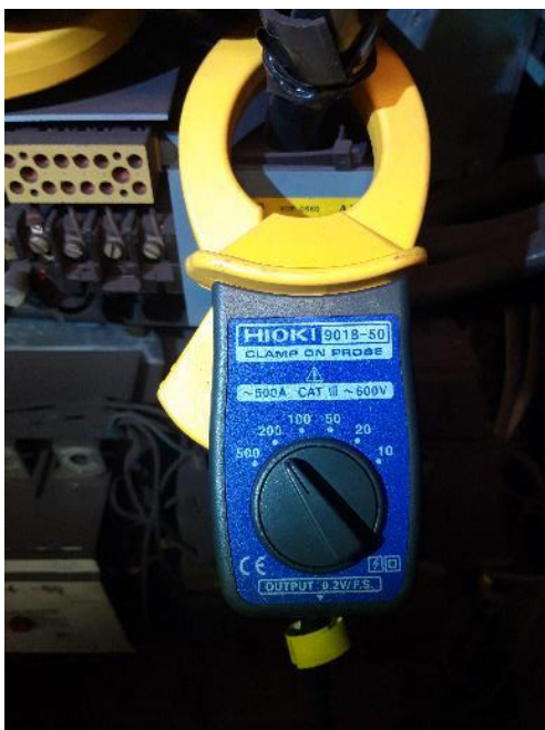
Kuva 7. Virtapihdin asetus ja asento johtimessa mittauksen aikana.
