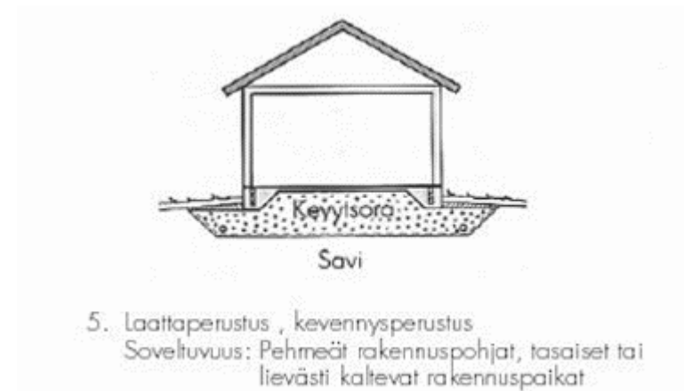
Kuva 37. (Kuva: Karvonen 2012) Maanvarainen laatta soveltuu hyvin tasaiselle rakennuspaikalle, sekä maanvaihdon määrä on vähäinen ja rakenne on yksinkertainen (Toroi 2012: 14-17).
