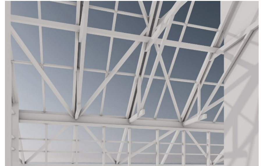
Kuva 86. Kattorakenne on inspiroitu vanhojen kirkkojen kattorakenteesta, jotta korkeassa kattorakenteesta ei tarvitse käyttää liimapuuta. Valkomalli on otettu viljelyhuoneesta, jossa kattorakenne jäisi avoimeksi, muualla yhteistiloissa tulee alakatto ja eriste.
