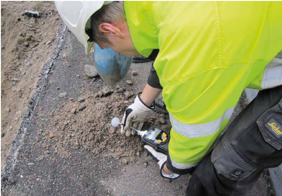
Kuva 13. Maanäytteestä mitataan öljypitoisuus. Kenttämittausten avulla määritellään kaivettavan alueen laajuus. (Tarja Asikainen 2013)
