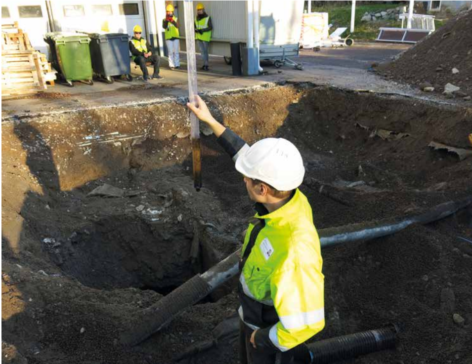
Kuva 11. Öljyllä pilaantuneen maan in situ -kunnostuskohteessa tehdään myös kunnostuksen aloituksen yhteydessä kenttätestejä. Kaivannosta otetussa vesinäytteessä näkyy öljyä. (Päivi Kärnä 2013)
