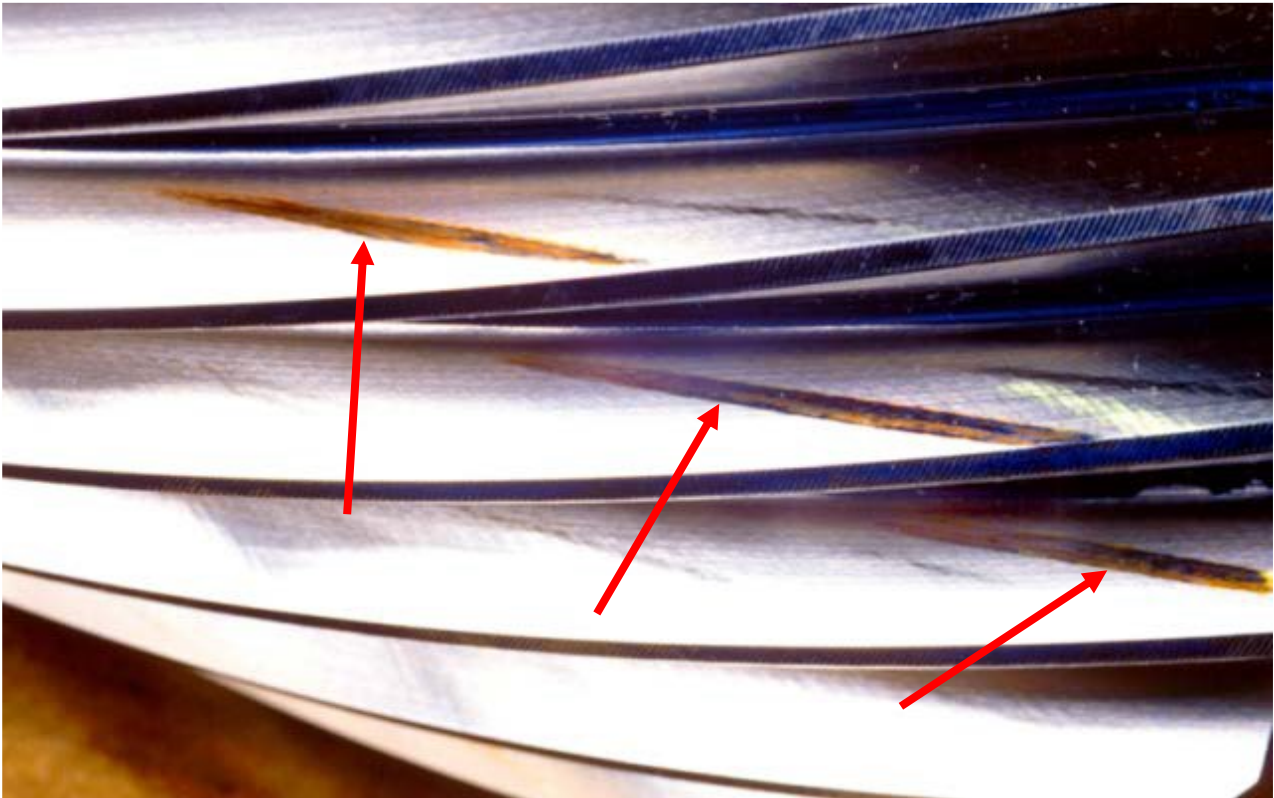
Kuvio 31 Kulumiskorroosio hammaspyörässä (Sheng Shawn, Fields Jason , Cooperman Aubryn Shields Matt. 2022.)
