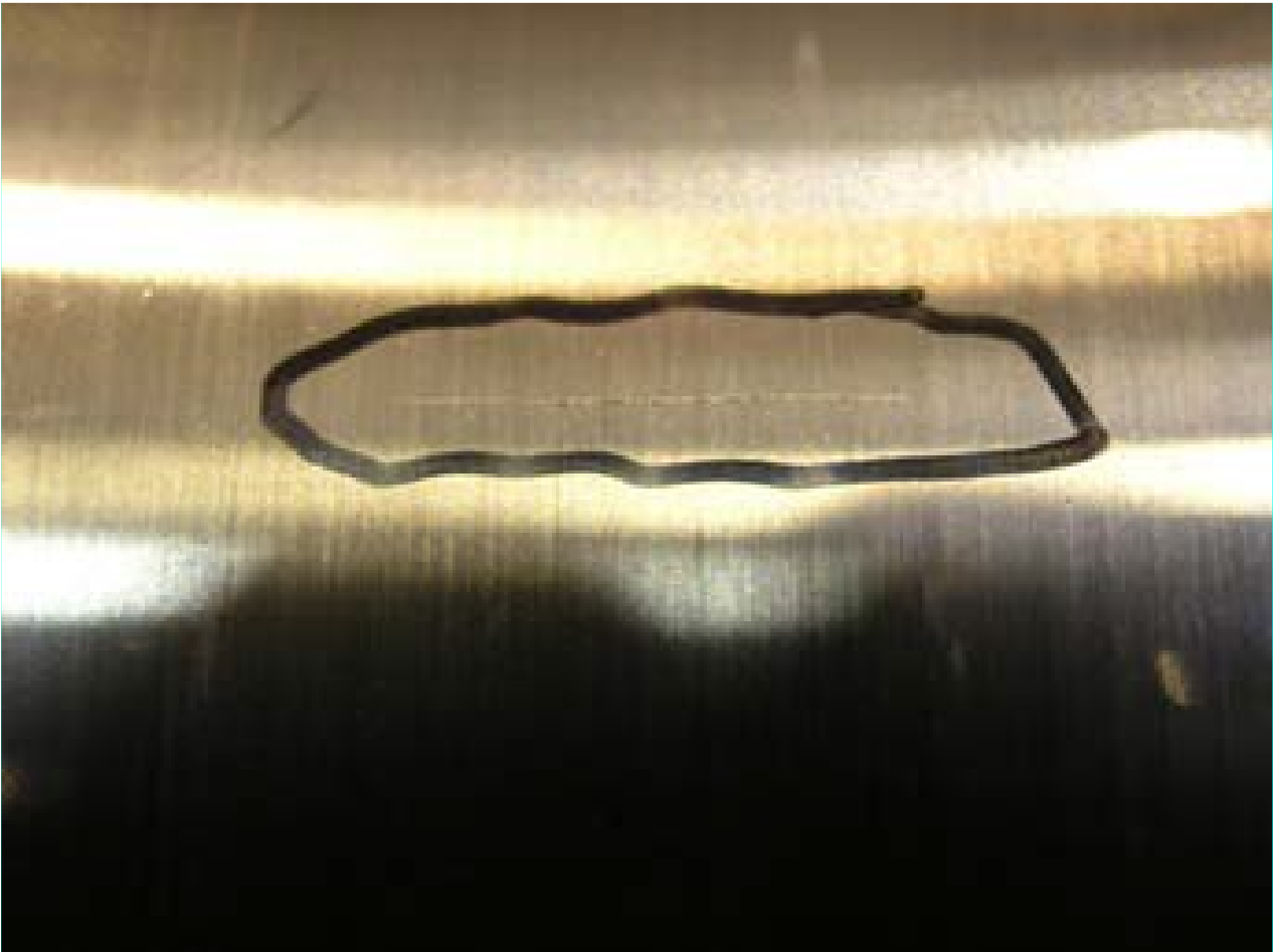
Kuvio 29 Aksiaalinen särö laakerissa.(Sheng Shawn, Fields Jason , Cooperman Aubryn, Shields Matt. 2022)
