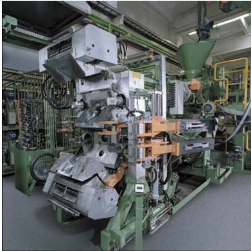
Kuva 15. Triplex-ekstruusiopää avattuna. Oikealla kasetit esimuotoilijalle ja suuraudalle. /27/
