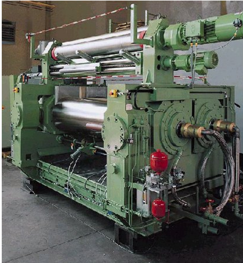
Kuva 1. Stockblenderillä varustettu sekoitusvalssi. /25/
