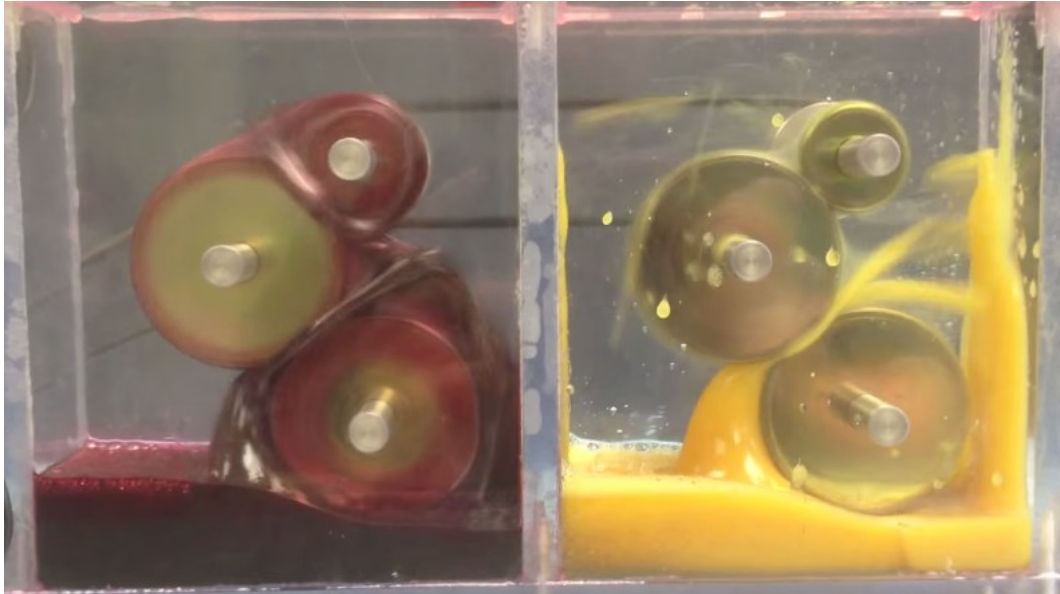
KUVA 10. Vaihteistoöljyn kerääntyminen ja tarttuvuus voideltaviin kohteisiin (Look for products that contain Duolec, Lubrication engineers, Inc)
