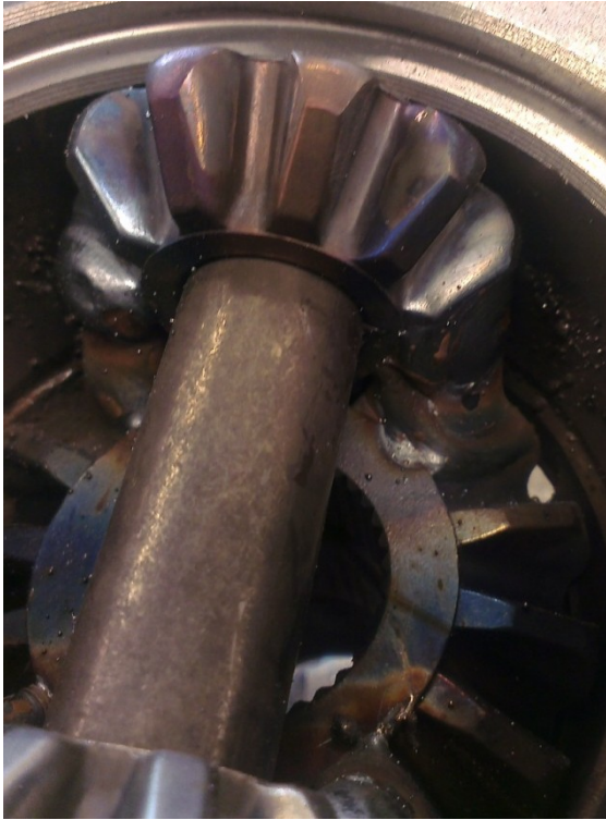
KUVA 19. Tasauspyörästön muuntaminen kiinteäksi
