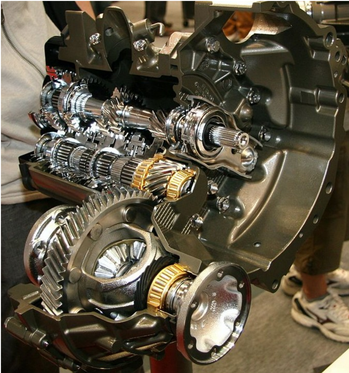
KUVA 2. Volkswagen 0A2-tyyppin käsivalinteisen vaihteiston poikkileikkaus (VW 0A2-tyyppin vaihteiston poikkileikkaus)
