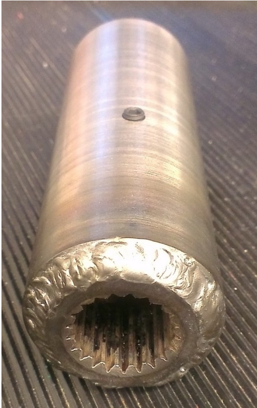
KUVA 27. Booriholkki asennettuna lisäakseliin
