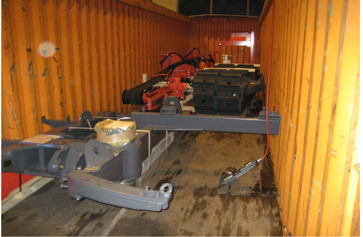
Kuva 4: Alarunko, syöttölaite ja telastot kontitettuna
