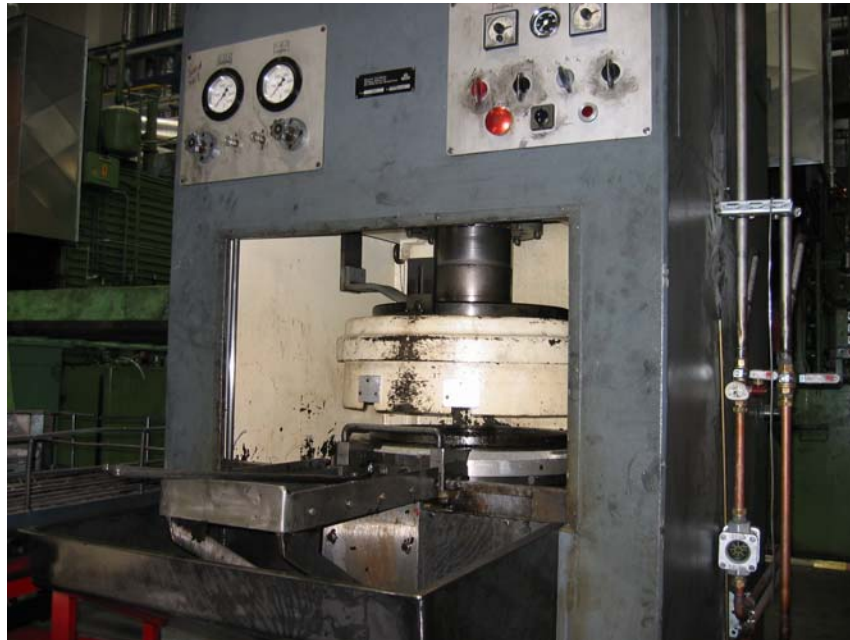
Kuva 2 Puristinkarkaisussa käytettävä puristin
