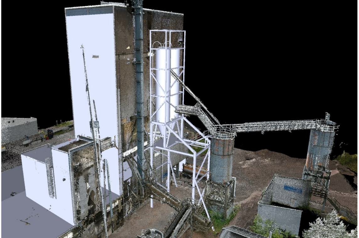
Kuva 15. Valmis teräsrakenne Navisworks-ohjelmassa.
