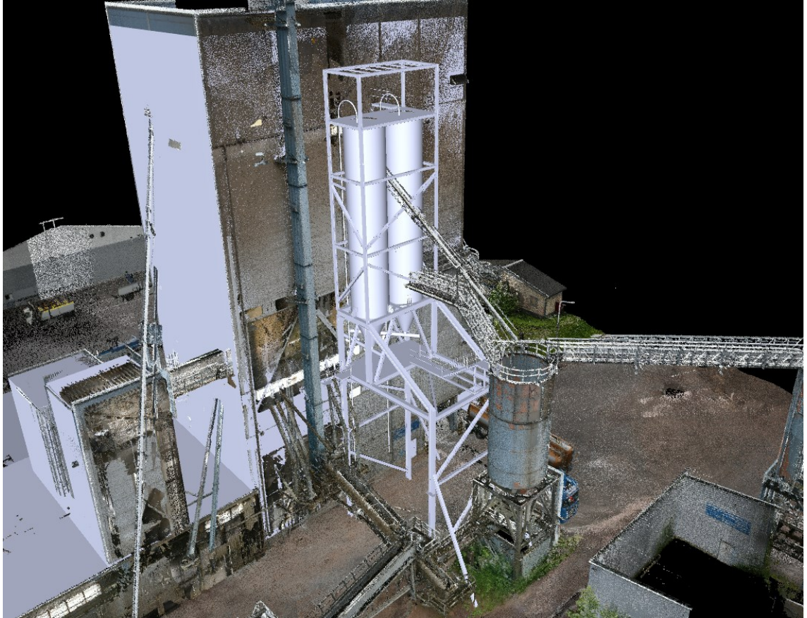
Kuva 16. Valmis teräs rakenne Navisworks-ohjelmassa.
