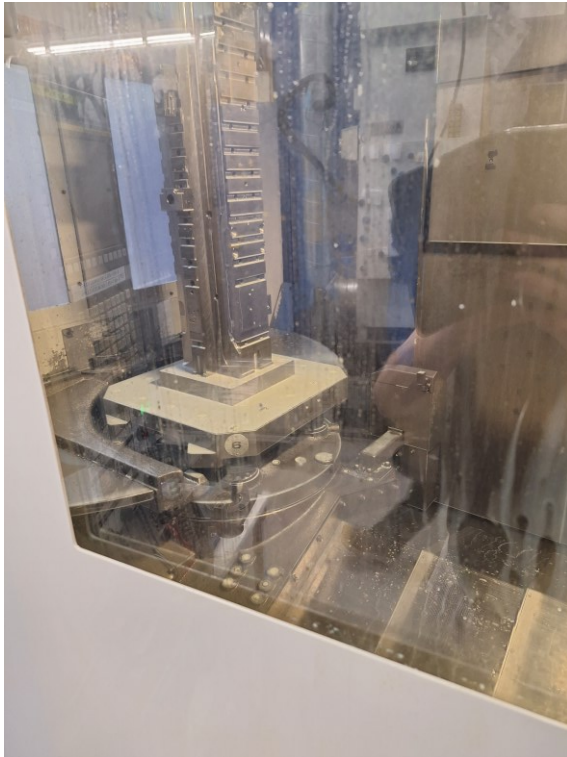
Kuva 3. Koneistuskeskuksen sisäosa (kuva: Miska Saarnijoki).
