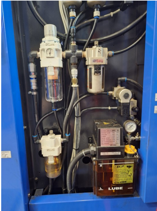
Kuva 5. Paineilman öljytin ja karan voiteluyksikkö (kuva: Miska Saarnijoki).
