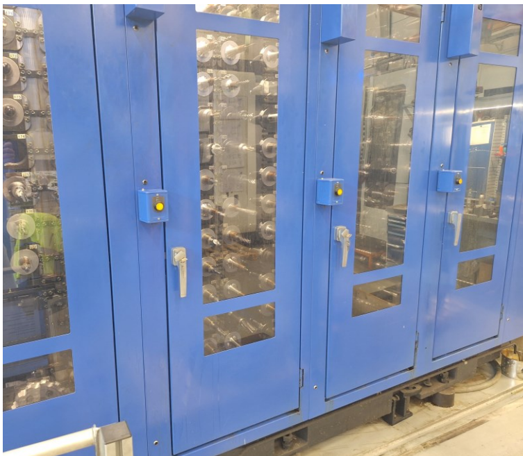
Kuva 9. Työkalumakasiini (kuva: Miska Saarnijoki).
