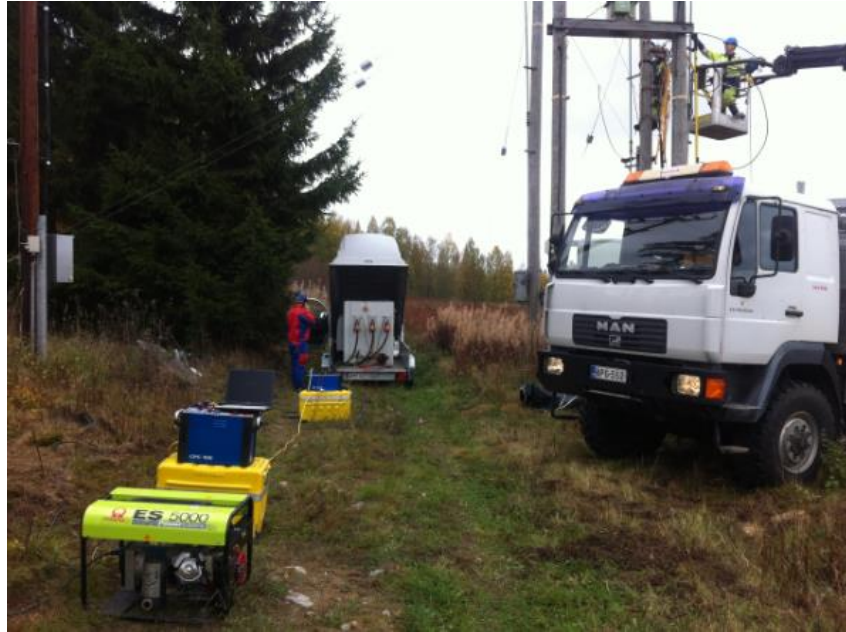
Kuva 17. Pitkän keskijännitekaapelin impedanssimittaus maasto-olosuhteissa. Mittauslaitteiston tarvitsema virta saatiin bensiinikäyttöisestä aggregaatista [31]
