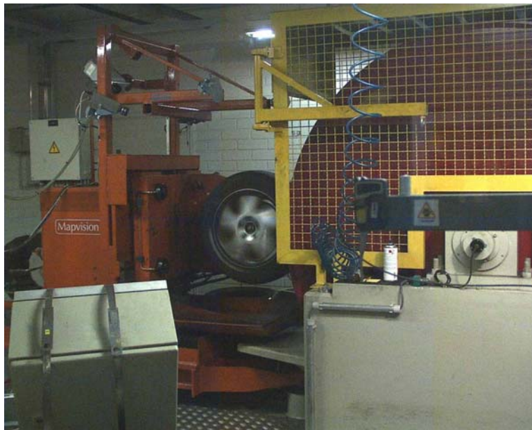
Kuva 10 Renkaankoestuskone (ZF Passau GmbH)
