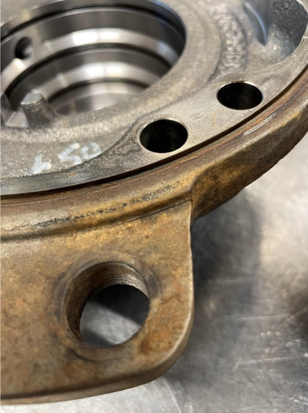
Kuva 23. Murtunut korvake, alasyöttömoottori (Tuominen, 2024, CC BY-NC-ND).
