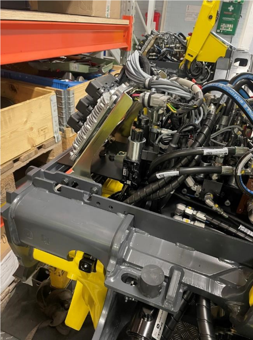
Kuva 8. H425-mallin sähköistys ja hydraulikka (Tuominen, 2024, CC BY-NC-ND).
