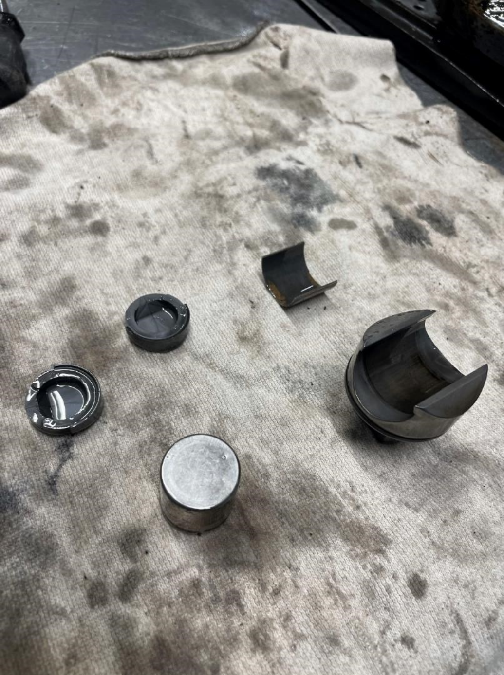
Kuva 21. Alasyöttömoottorin mäntä, rulla, rullan liuku, männän pidätin (Tuominen, 2024, CC BY-NC-ND).
