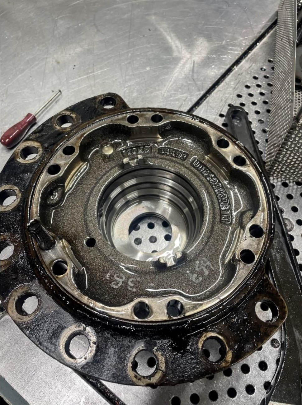
Kuva 17. Alasyöttömoottori aukaistuna, kannen irrotus (Tuominen, 2024, CC BY-NC-ND).
