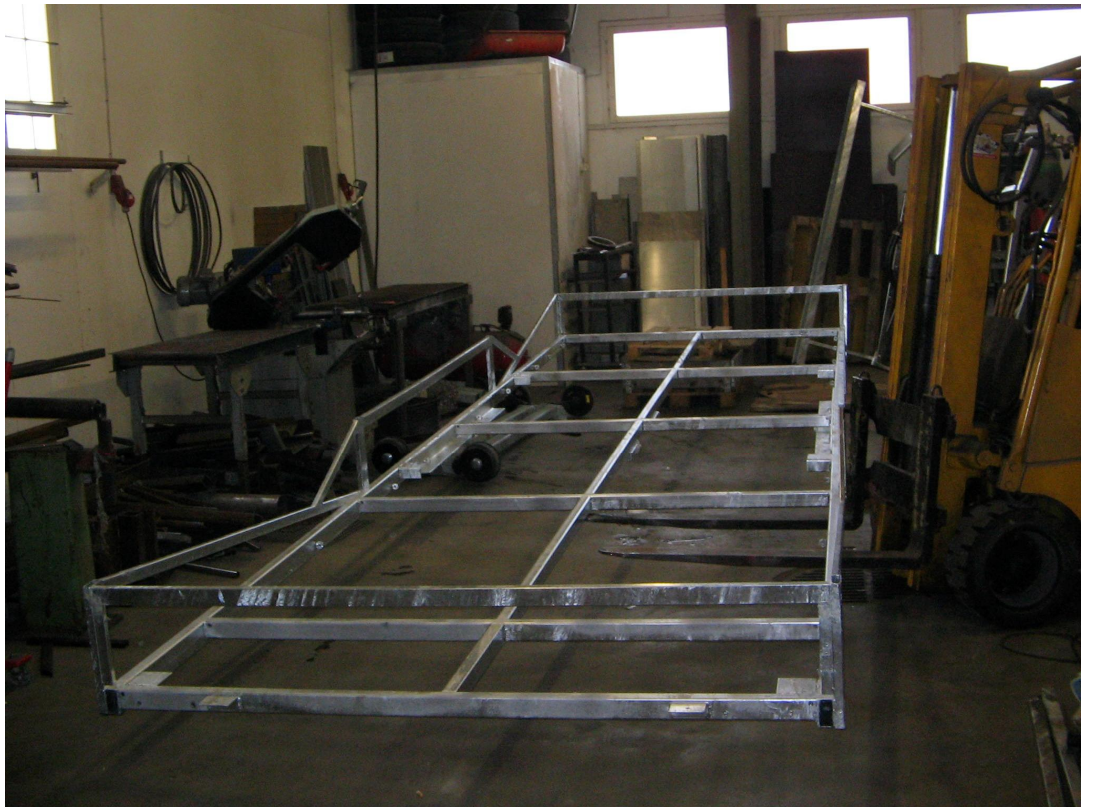
Kuva 19. Rungon loppuosa sinkittynä
