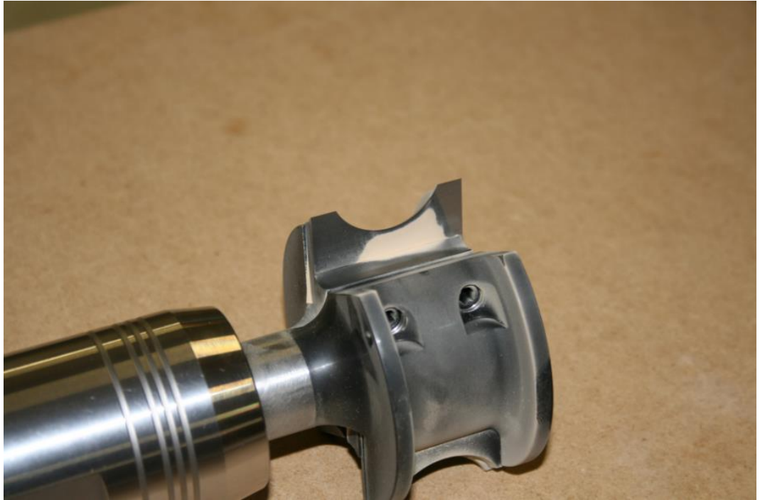
KUVIO 32. Työstöpurua rungon lastutilassa koeajon jälkeen
