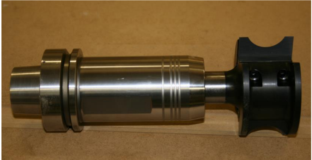
KUVIO 27. Testattava varsijyrsin ja siihen kiinnitetty istukka kiinnitystä varten
