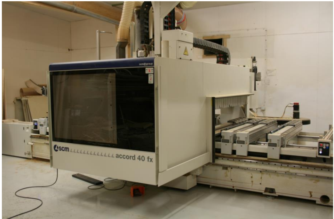
KUVIO 28. SCM Accord 40 FX CNC-työstökeskus
