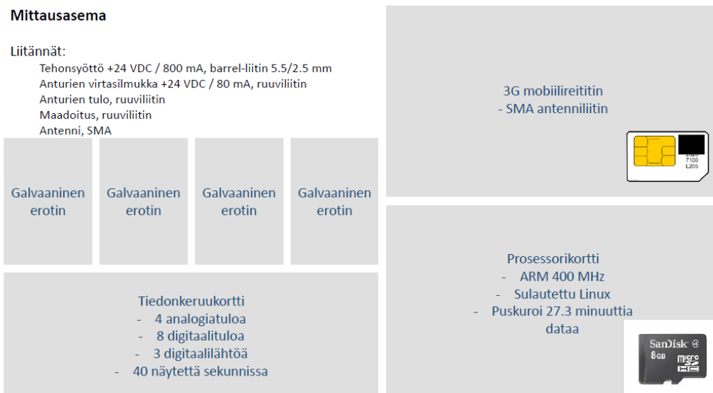
KUVA 3. Mittausaseman sisältämät komponentit (Seurantapalaveri Kuopion Energia 2014-12-13.)
