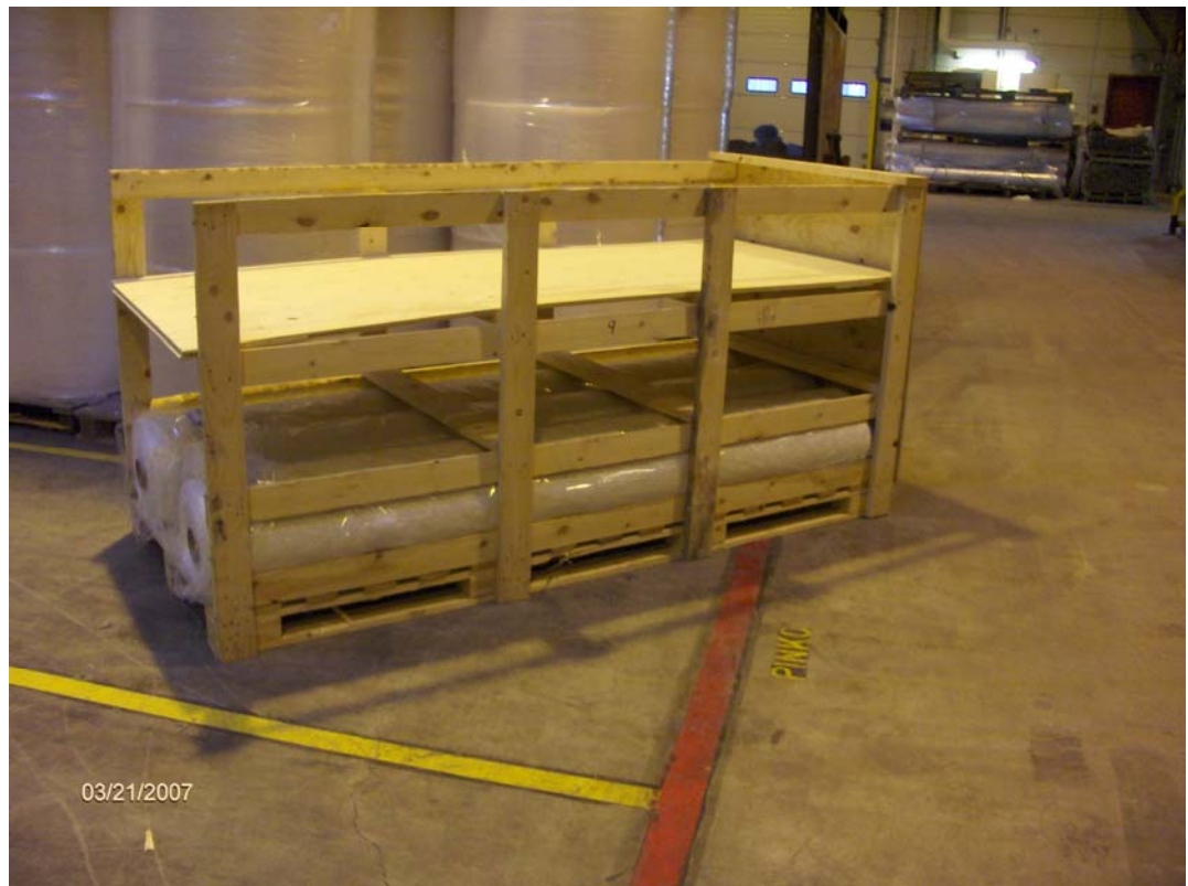
Kuva 10: Pienien rullien kuljetushäkki
