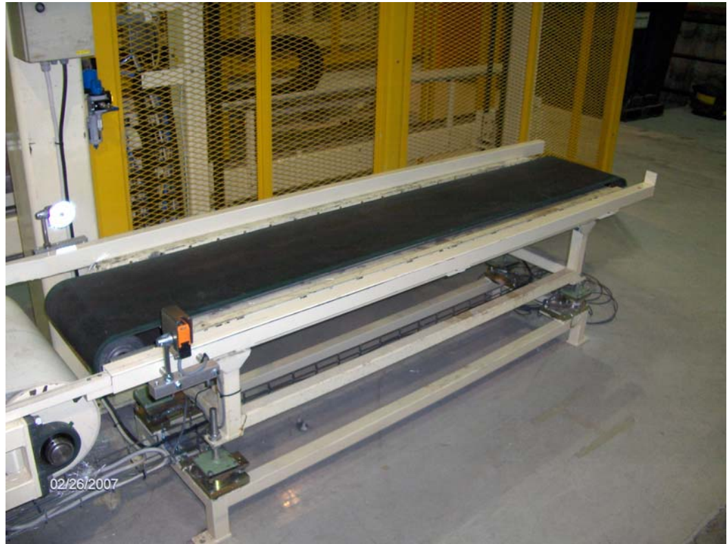
Kuva 5: Uusittava hihnakuuljetin ja vaaka-anturit
