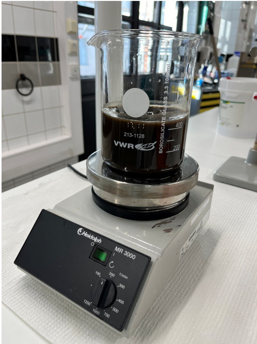
Kuva 1. Kuivatun mädätejauheen uuttaminen magneettisekoittajalla
