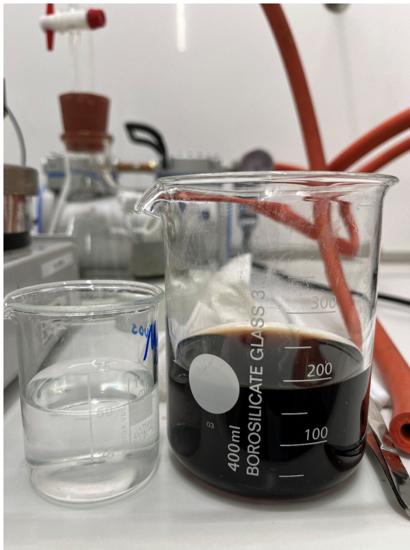
Kuva 5. Vasemmalla magnesiumkloridin heksahydraatista valmistettu liuos. Oikealla näyteliuos, jonka pH on säädetty 9,5:een ja johon ammoniumkloridi on liuotettu.
