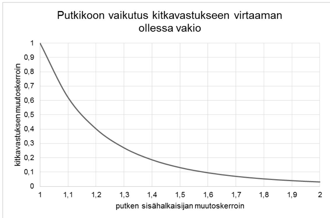
Kuva 23. Putkikoon vaikutus kitkavastukseen, kun edellä mainitut ehdot täyttyvät [24].
