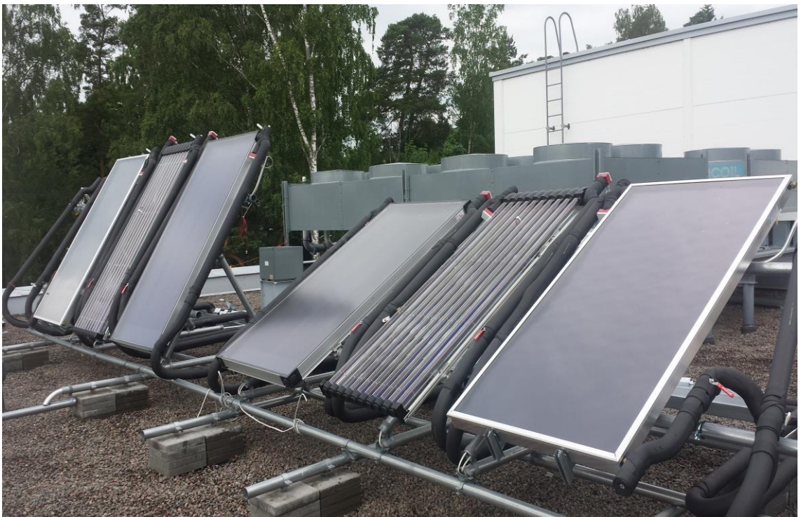
Kuva 38. MetroSol-aurinkoenergiälaboratorion aurinkokeräimet. (Kuva tekijän.)
