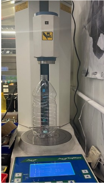
Kuva 8. Ylhäältäpäin kohdistuvan voiman testilaitteisto
