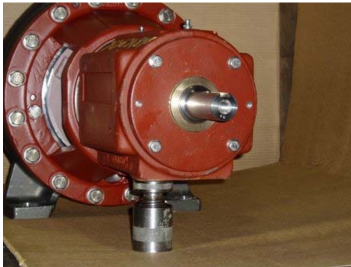
Kuva 17 Säädettävä tukijalka pumpussa
