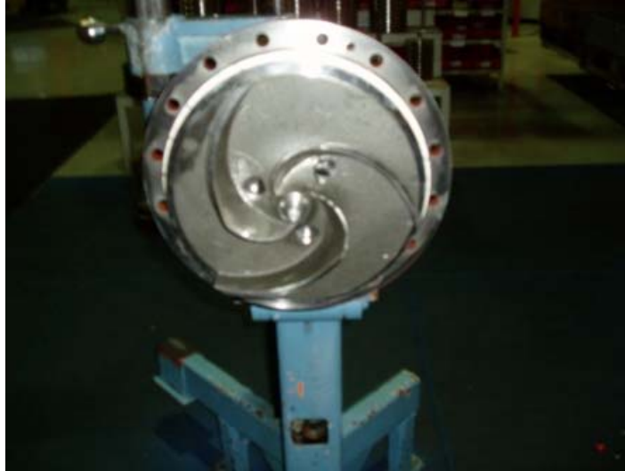
Kuva 14 Juoksupyörä kiinnitettynä vaihtoyksikköön
