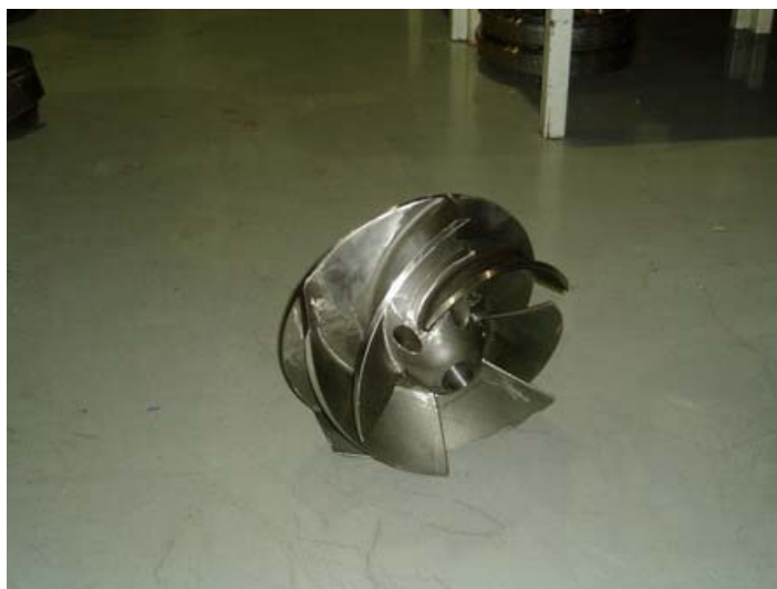
Kuva 7 Juoksupyörä avoin Ø420mm
