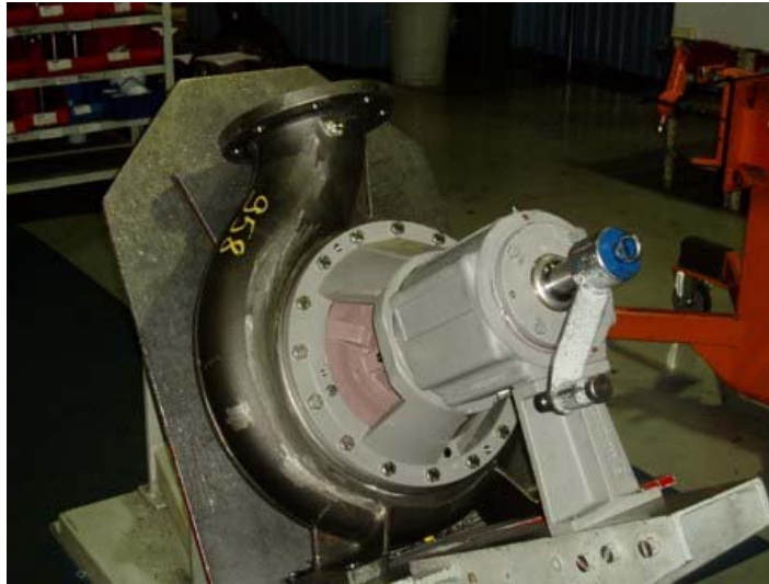
Kuva 6 Koeajoon valmis pumppu
