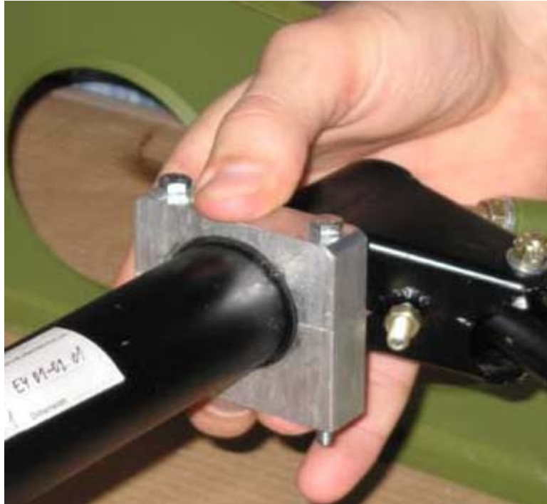
Kuva 9. Alumiinisten laakeripintojen sovitusta ohjaussauvan runkoon.
