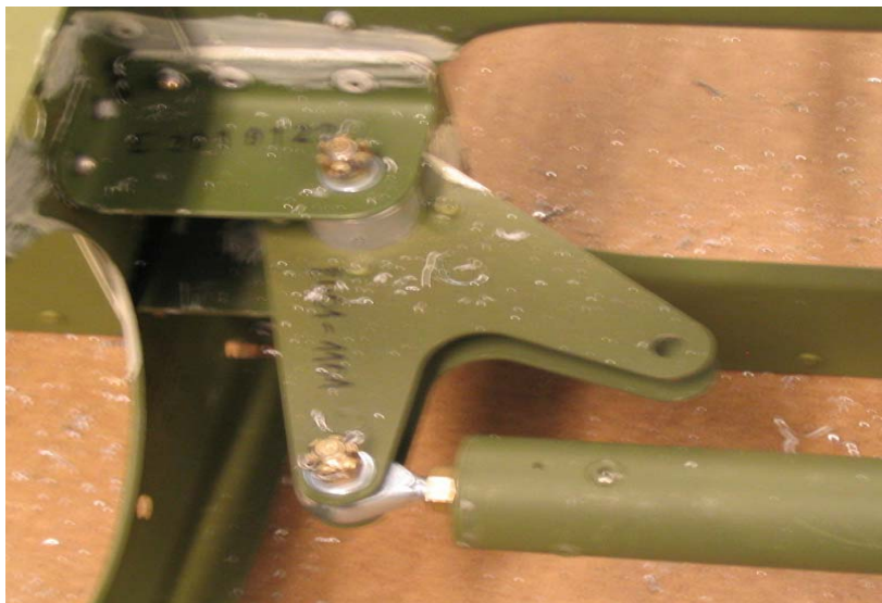
Kuva 10. Siivessä sijaitseva vipu, johon kiinnitetty työntötanko.
