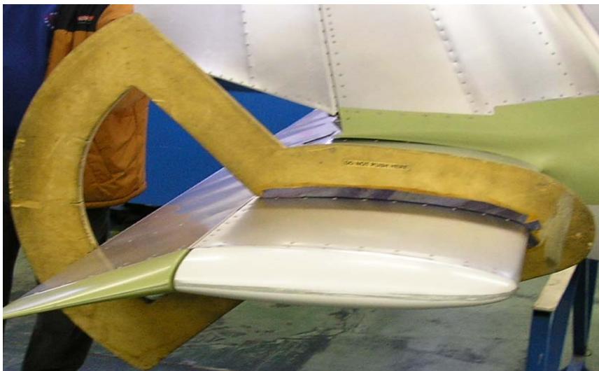
Kuva 12. Korkeusperäsimen asteiden säädössä tarvittava astemitta
