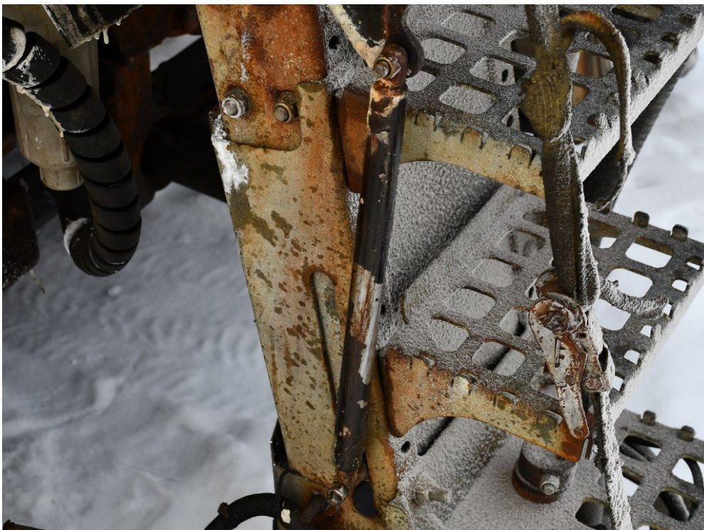
Kuva 21. Sirottimen hännän nostoa keventävä kaasujousi (Kuva: Lauri Heija)
