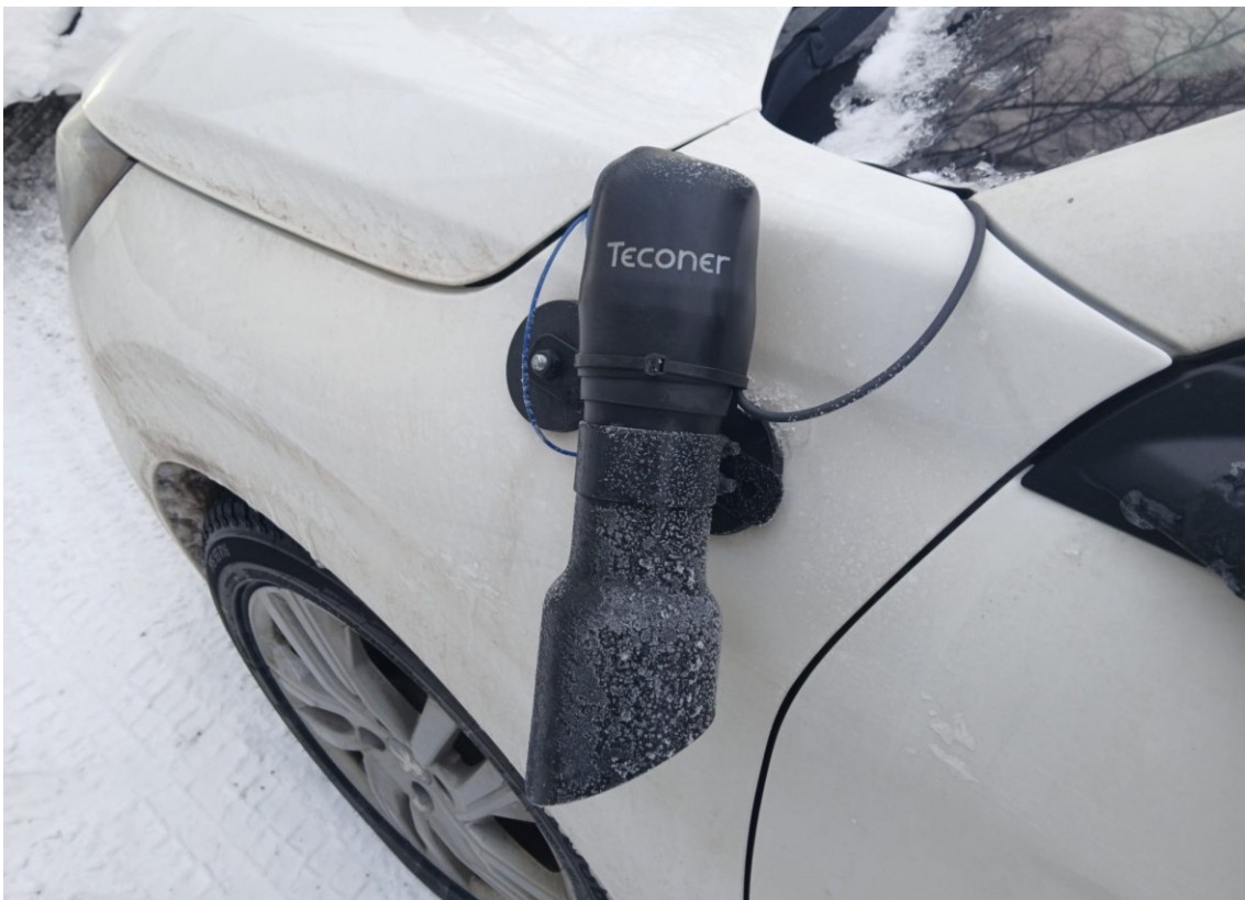
Kuva 9. Teconer RCM511-anturi asennettuna autoon (Kuva: Lauri Heija)
