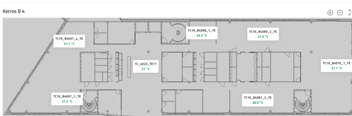
Kuva 7. Esimerkki kerrosta B4 Caverion SmartView -järjestelmästä.
