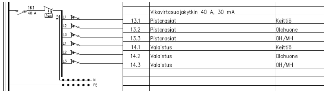
Kuva 10. Kontaktorihjattu vikavirtasuojaryhmä ryhmäkeskuksessa.
