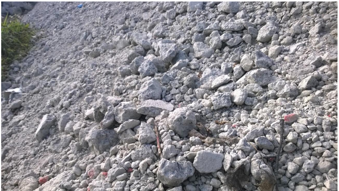
Kuva 1. Betonimursketta käytössä jakavassa kerroksessa.
