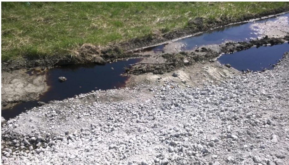
Kuva 4. Betonimurskeen aiheuttamaa veden värjäytymistä.
