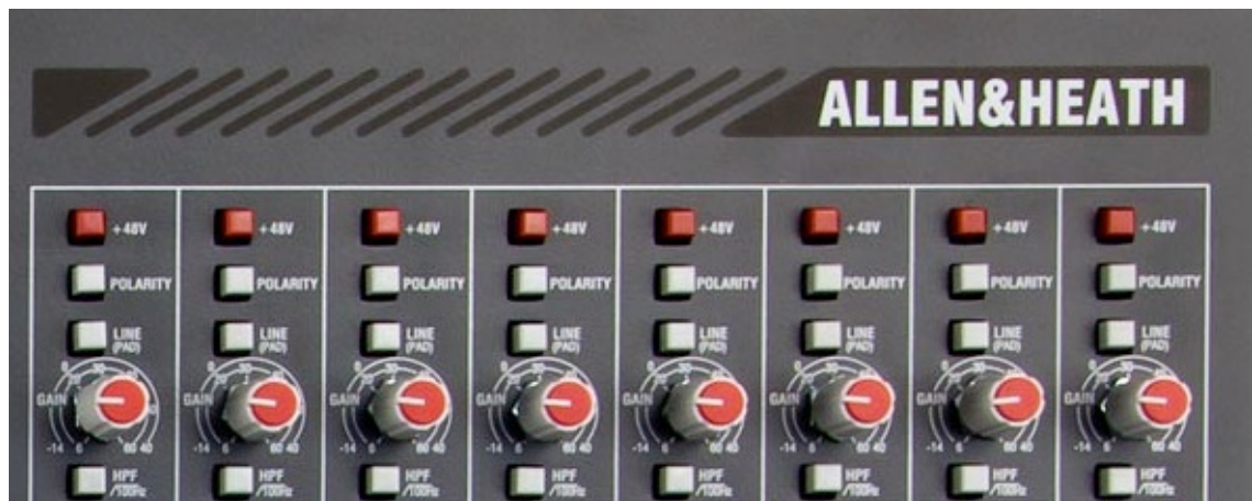
KUVA 18. Allen&Heath valmistajan GL2400 äänipöydän kanavan etuasteosio. Siinä on esillä perinteiset ominaisuudet, kuten phantom-virransyöttö (+48V), vaiheenkääntö (Polarity), signaalin vaimennus ja sisääntulon valinta (Line/Pad), vahvistuksen säätö (Gain) ja Ylipäästösuodin (HPF). (Kuva: www.allen-heath.com )
