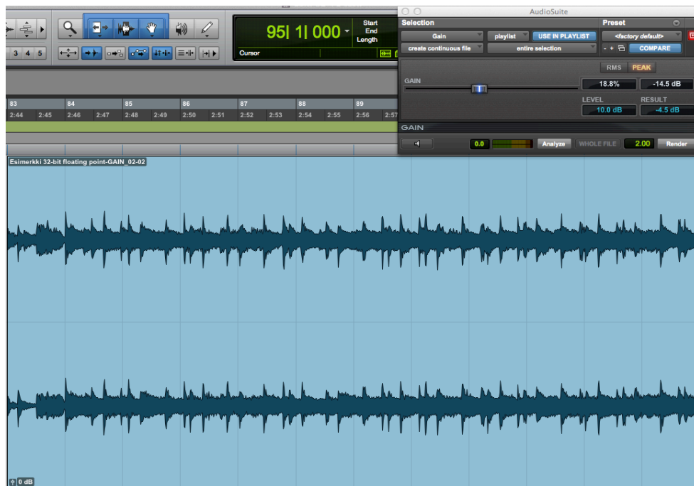
KUVA 12. Tiedoston taso on laskettu takaisin Gain audiosuite-liitännäisellä ja huiput ovat palautuneet normaaleiksi. 24-bit fixed point-bittisyvyydellä tämä ei onnistu. (Kuva: Jarno Valkonen)
