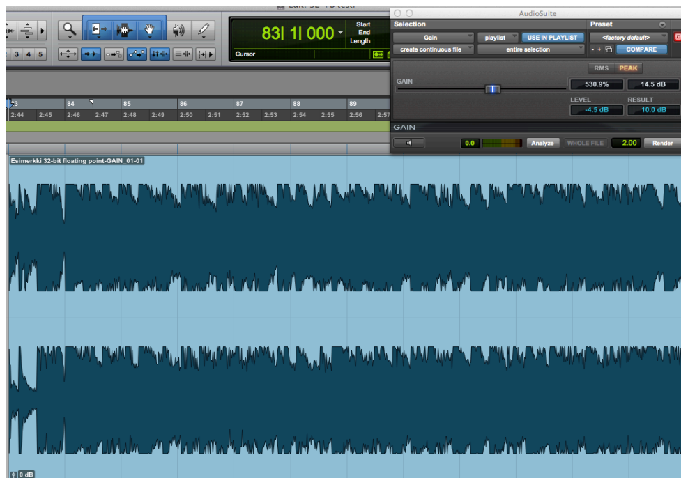
KUVA 11. Tiedoston tasoa on nostettu Gain audiosuite-liitännäisellä niin paljon, että sen huiput ovat leikkaantuneet. (Kuva: Jarno Valkonen)
