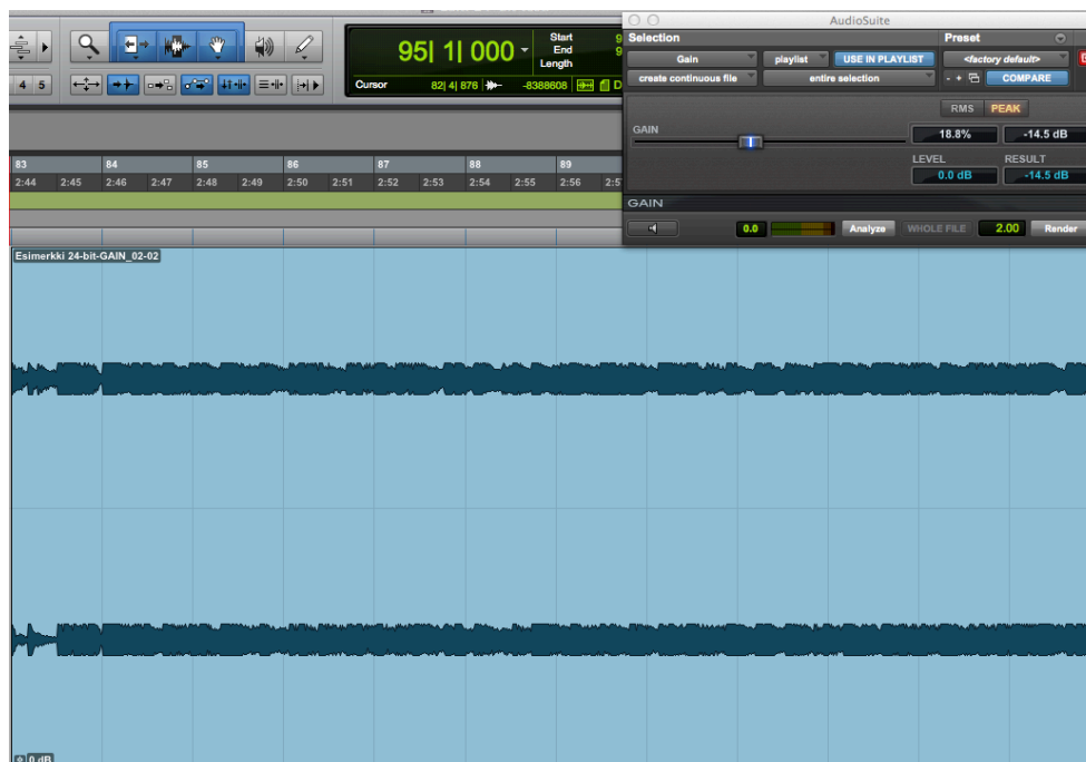
KUVA 15. Tiedoston taso on laskettu takaisin Gain audiosuite-liitännäisellä ja huiput ovat yhä leikkaantuneet. Tiedoston taso on vain laskenut. (Kuva: Jarno Valkonen)
