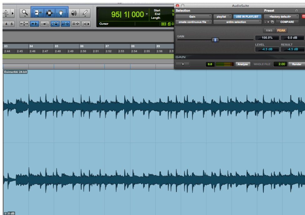
KUVA 13. Pro-Tools-projekti ja tiedosto ovat bittisyvyydeltään 24-bit fixed point. Tiedosto on analysoitu Gain audiosuite-liitännäisellä ja sen huiput ovat -4,5 dBFS. (Kuva: Jarno Valkonen)
