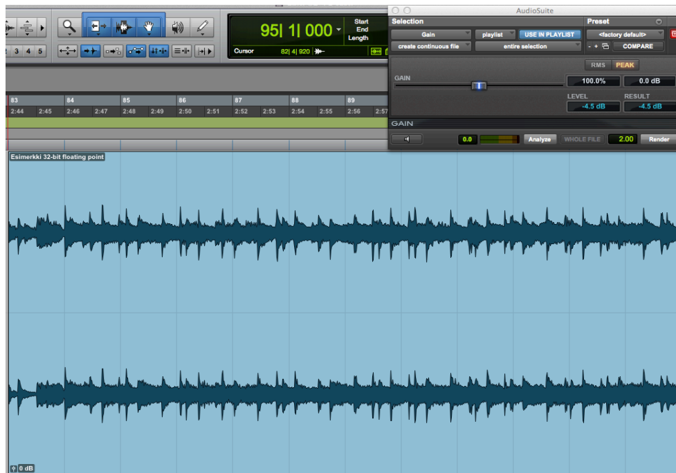
KUVA 10. Pro-Tools-projekti ja tiedosto ovat bittisyvyydeltään 32-bit floating point. Tiedosto on analysoitu Gain audiosuite-liitännäisellä ja sen huiput ovat -4,5 dBFS. (Kuva: Jarno Valkonen)
