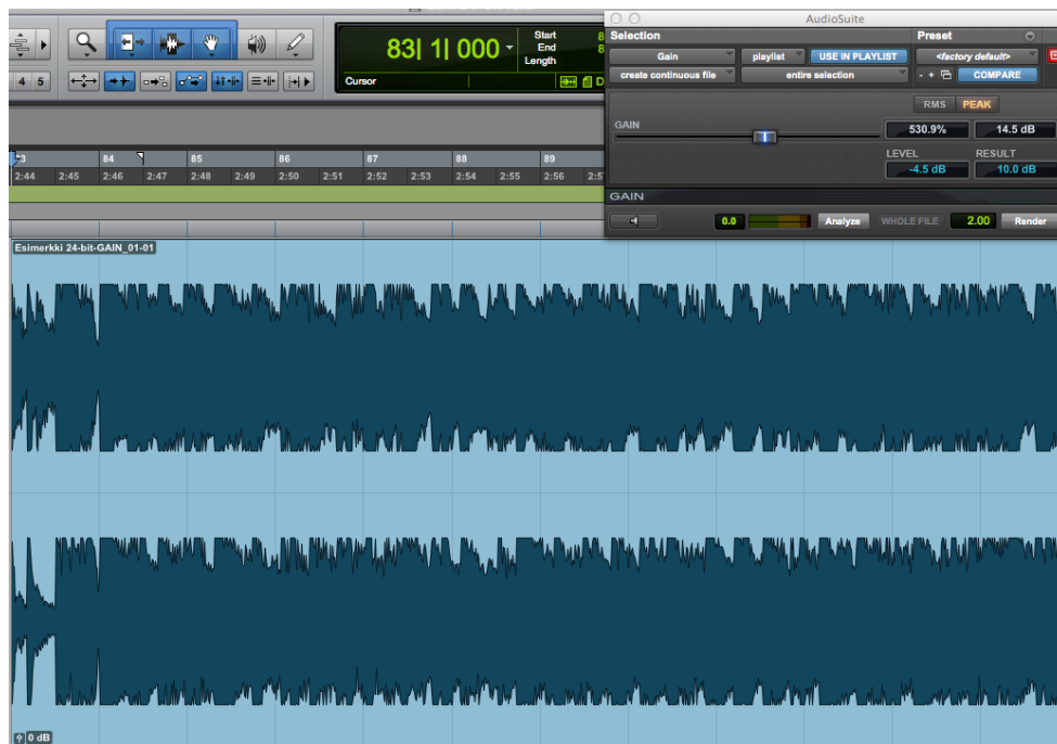
KUVA 14. Tiedoston tasoa on nostettu Gain audiosuite-liitännäisellä niin paljon, että sen huiput ovat leikkaantuneet. (Kuva: Jarno Valkonen)
