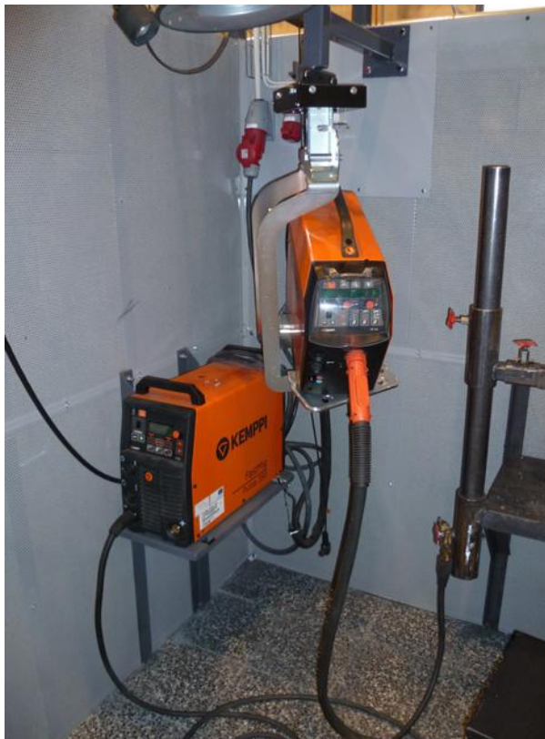
Kuvio 21. Nuorisoasteen hitsauskopeissa koneet eivät ole lattialla.
