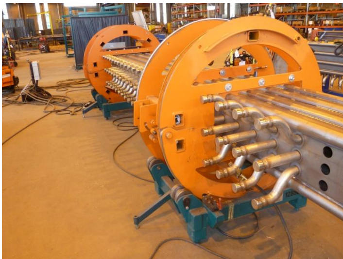
Kuvio 9. Pyöritysrullasto ja kappaleen kiinnityskehikot Metso Oy:ssä Lapualla.
