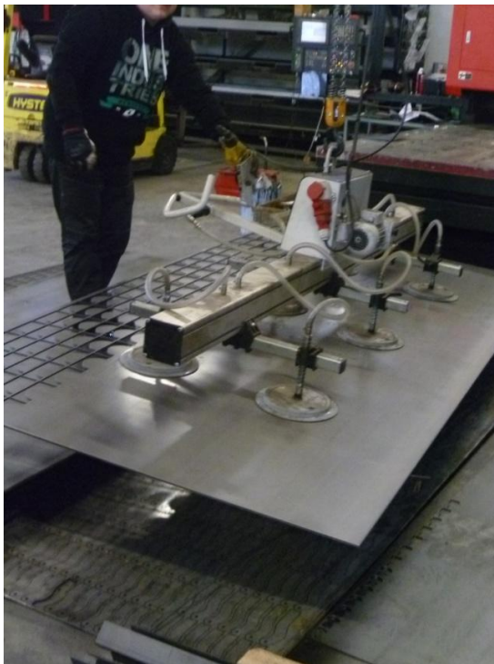
Kuvio 12. Alipainetoiminen levynostin Jusmara Oy:ssä.
