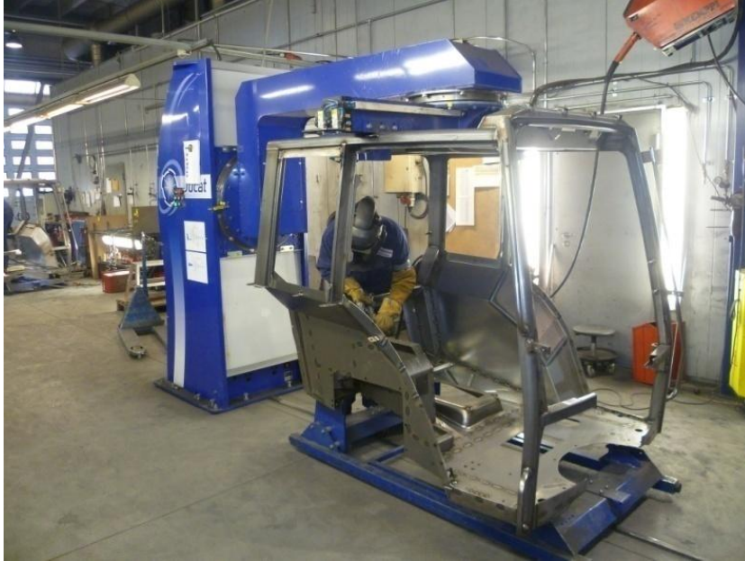
Kuvio 8. Ohjaamon hitsausta pyörityslaitteen avulla Maaseudun Kone Oy:llä Ylihärmässä.
