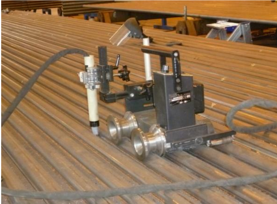
Kuvio 6. Itse valmistettu ryömijä Metso Oy:ssä Lapualla.
