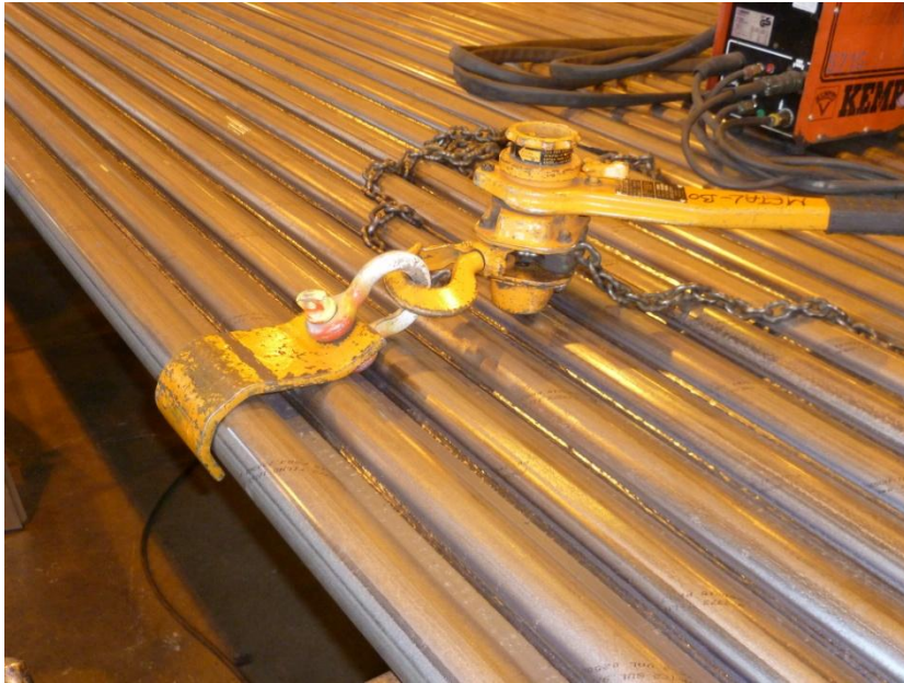
Kuvio 11. Ketjutaljaljalla voidaan pakottaa hitsauksessa vääntyvät metalliosat paikoilleen. Metso Oy Lapua.
