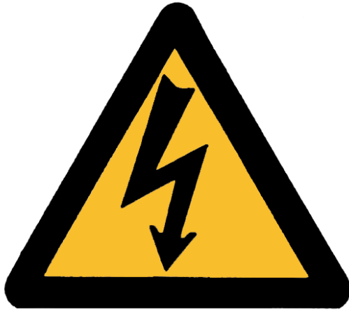
KUVA 1. Yleinen vaarallisesta jännitteestä varoittava kilpi (SFS 6002)
