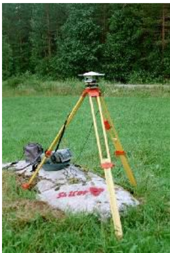
Figur 26; Ett GNSS instrument placerat över en markerad höjdfixpunkt med hjälp av en trefot. Det kan vara en Rover eller en Base, vilket ger den olika egenskaper. I vanliga fall används en basstation, alltså Base. Rover är en rörlig mottagare och den brukar flyttas. En statisk GPS mätning utförs. (Lantmäteriverket i Finland, GNSS instrument, u.d.)
