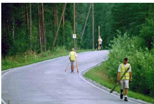
Figur 14; Två mät tjänstemän med lator, varav den enes blir mätt mot i bakgrunden. Mannen mellan dem använder sig av ett avvägningsinstrument uppställd på en trefot. (Lantmäteriverket i Finland, u.å.)
