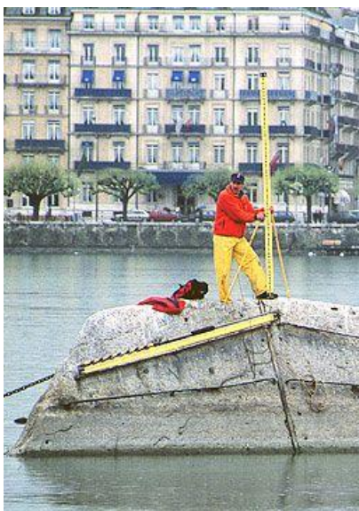
Figur 2; Höjdfixpunkt på en klippa i hamnen i, på rätoromanska Genevra och på franska Genève, i Schweiz. En avvägning är på gång. (Swisstopo, Einen Hohenfixpunkt im Genf, o.d.; Firmendb , verschiedene Namen auf Genf, 2007-2014)
