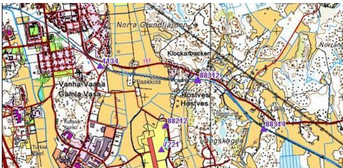
Figur 40; Höstves stompunkter i höjd av första klass och 7221 av tredje klass. (Lantmäteriverket i Finland, Höstves stompunkter i höjd av första och tredje klass, u.å.)
