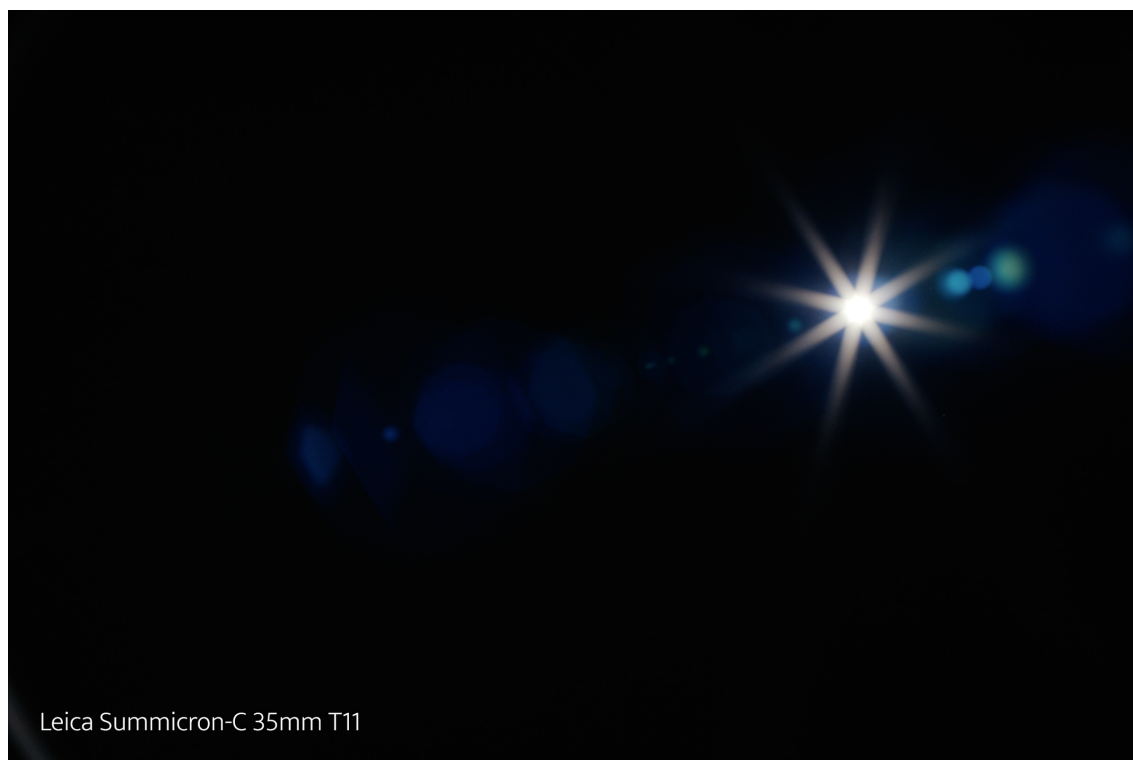
KUVA 26. Leica Summicron-C 35 mm on kahdeksanlamellinen, joten se muodostaa kahdeksan sakaraa. (Metsälä 2025)
