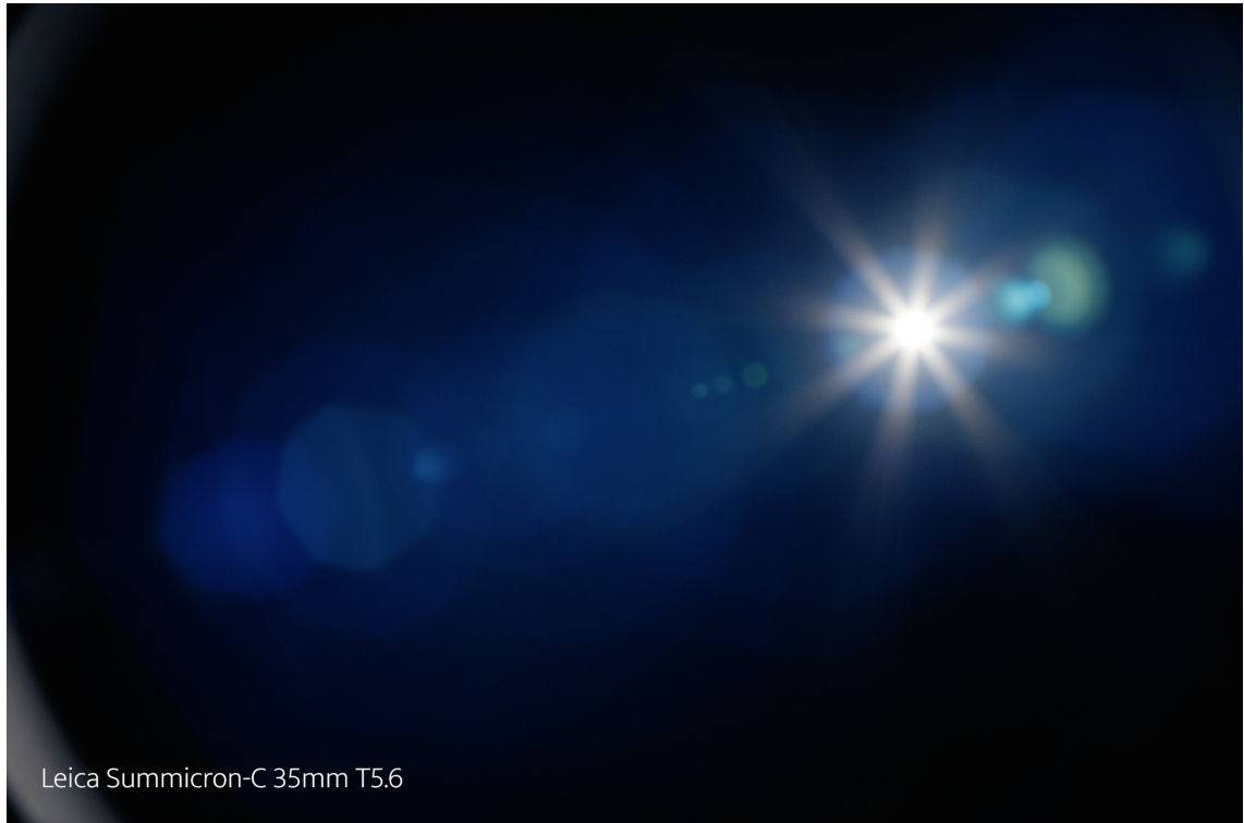
KUVA 11. Leica Summicron-C 35 mm -objektiivin iiriksen aavekuva on oktagonin muotoinen. (Metsälä 2025)
