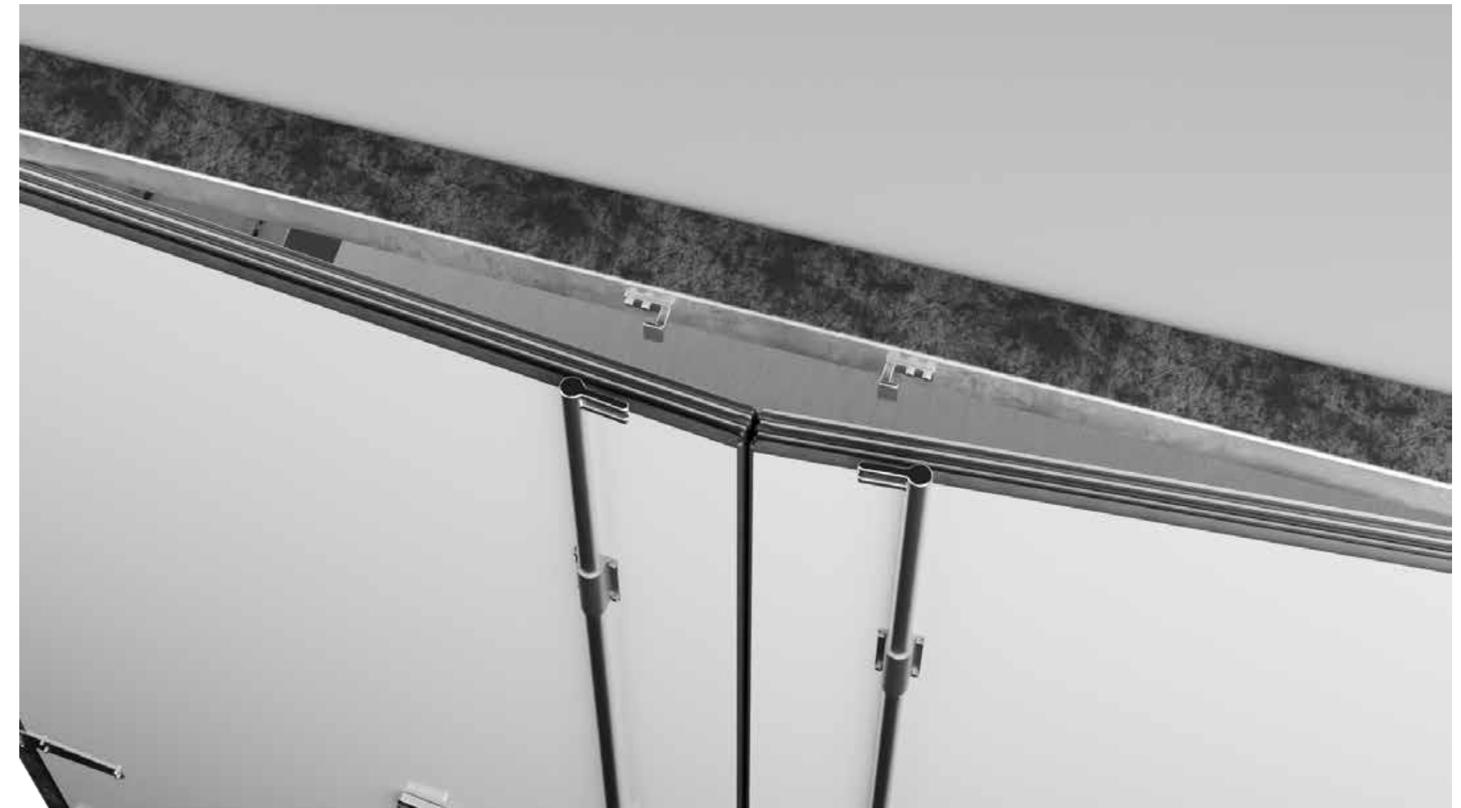
Kuva 57. Ovien avaus- ja sulkemisjärjestyksellä ei ole väliä. Tämä mahdollistaa ympäristöön mukautuvan kuorman purkamisen
