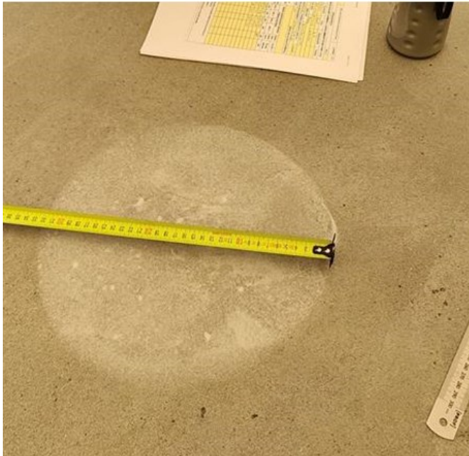
Kuva 7 Lasihelmien levinneisyyden mittaus (Skanska Infra Oy)
