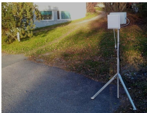
KUVA 21. Vivagon poistumisvalvontatukiasema ja suunta-antenni.
