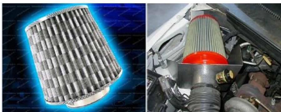
KUVA 13 Ilmansuodattimia henkilöautossa (Tharewal ym. 2013, 29)
