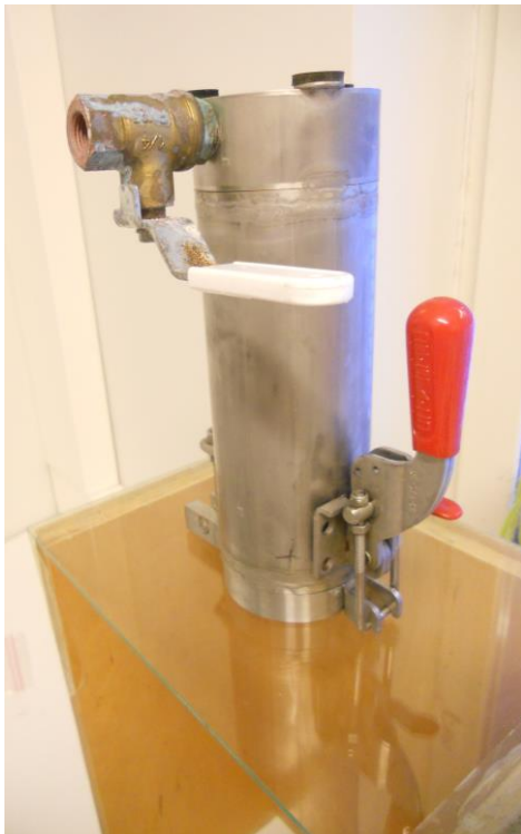
KUVA 17 Mason Jar-testausasetelma (Kuva: Jasmin Eeva 2015)
