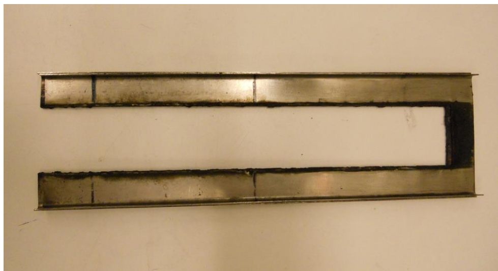
KUVA 21 U-muotoinen näytepidin, vasemmassa reunassa ensimmäinen merkkiviiva (Kuva: Jasmin Eeva 2015)
