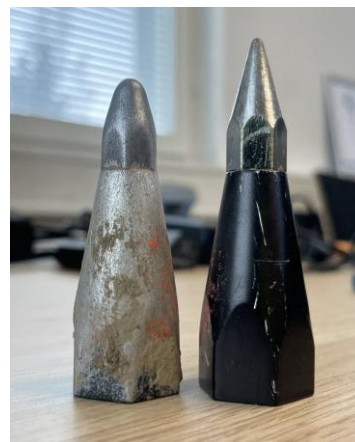
KUVA 21. Kartoitussauvan kärkikappaleet (Kuva: Alex Heikkilä).
