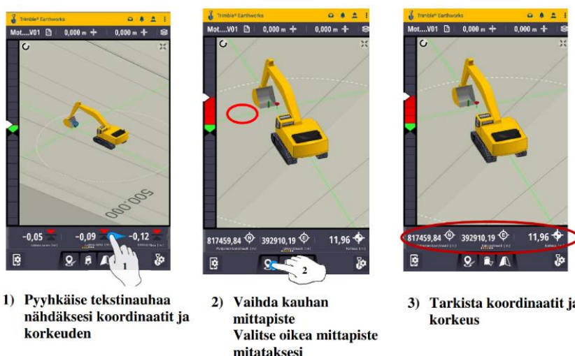
KUVA 26. Työkoneen tarkastusmittaus (Sitech Trimble EarthWorks käyttöohje n.d.).
