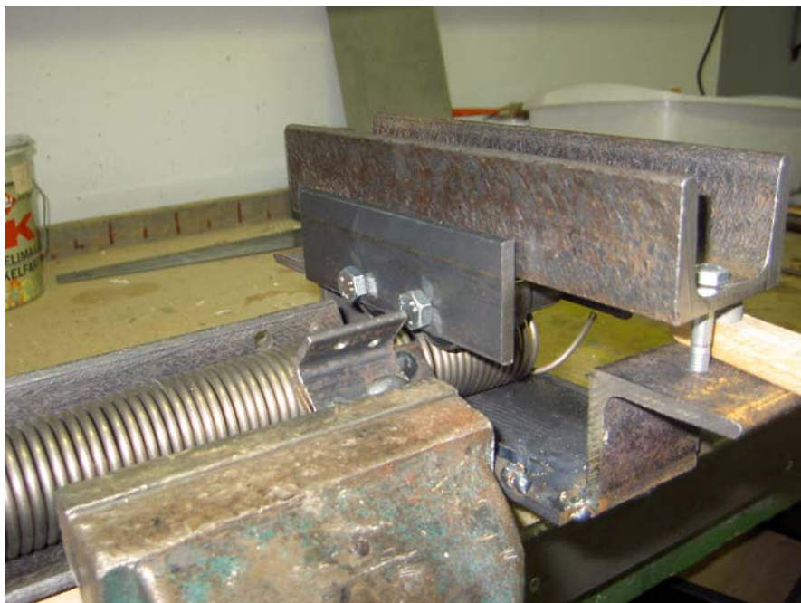
Kuva 21 Spiraali ja telapari on kiinnitetty
