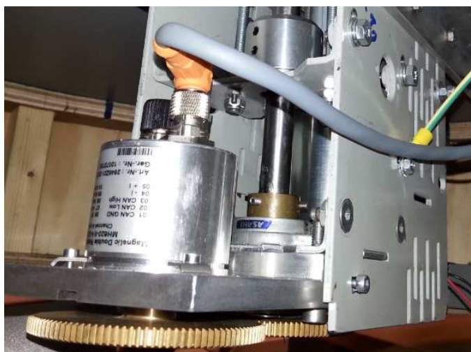
Kuva 7. Kulma-anturi kiinnitettyä mallin pohjaan
