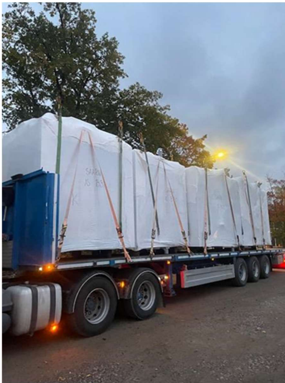
Kuva 5. KPH-elementit toimitettuna. Suojamuoviin merkattu työmaan nimi ja asunto, johon elementit asennetaan. (Kauppinen, 2024.)
