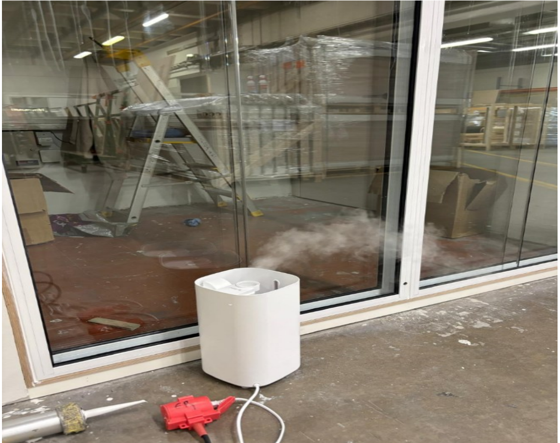
Kuva 15. Järjestelmän lasien välisen tilan suhteellisen ilmankosteuden nostaminen ilman virtauksen ollessa testihuoneeseen päin.
