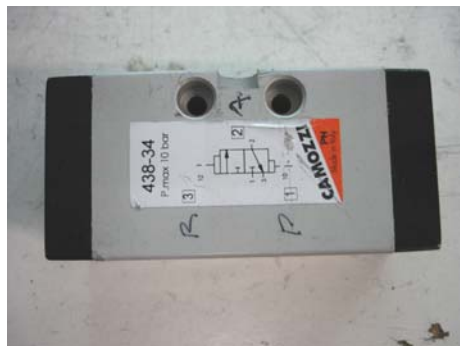
Kuvat 15 ja 16. Camozzin 3/2- sekä 5/2-venttiilit
