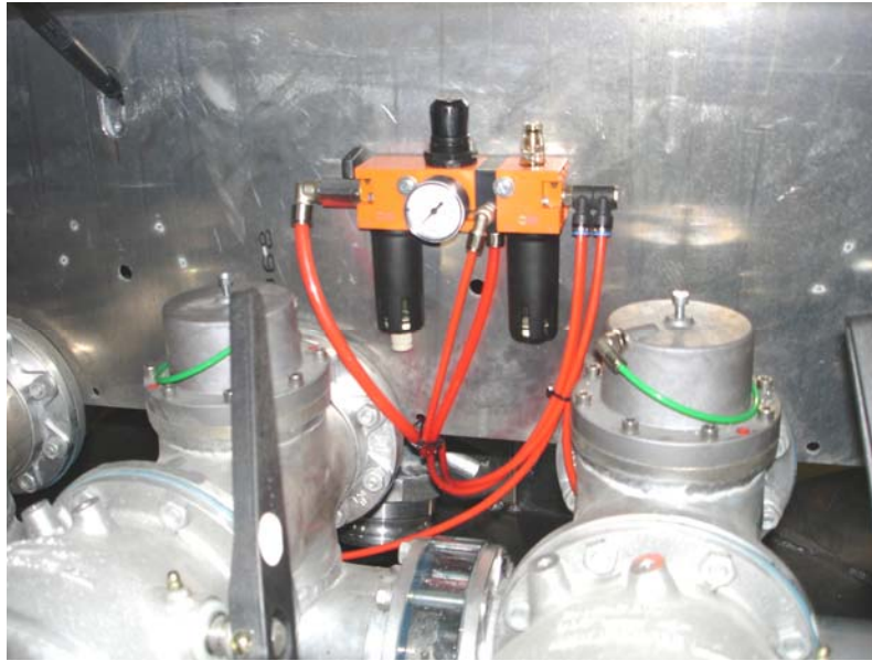
Kuva 26. Huoltosarja asennettuna osaksi säiliöajoneuvon järjestelmää
