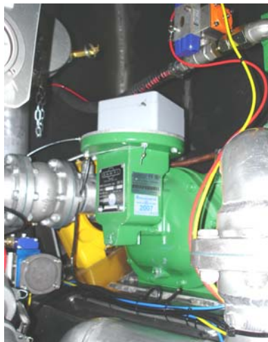
Kuvat 65 ja 66. Sampi-mittari ja pulssianturi, sekä Futura-ohjausyksikkö
