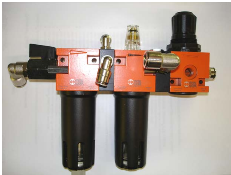
Kuva 24. Metal Workin valmistama huoltolaite, jossa vipuventtiili
