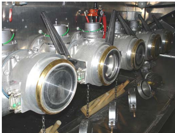
Kuva 56. Jakotukkiin asennettuja API-venttiilejä
