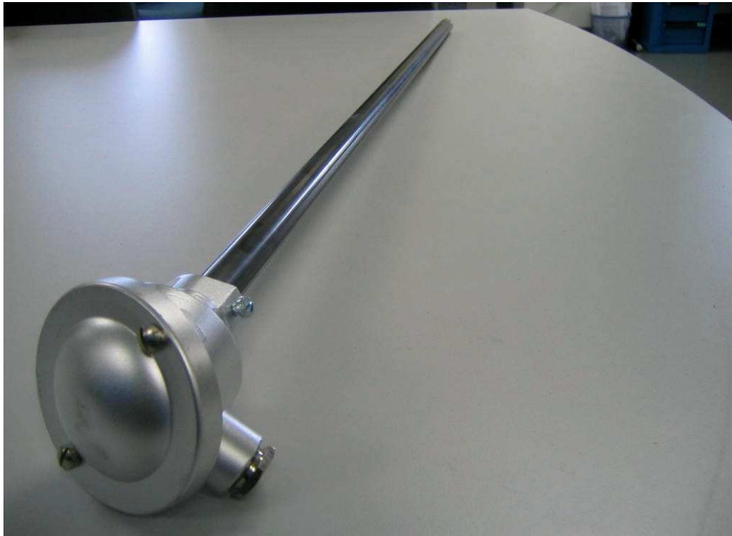
Kuva 12 Uuniin asennettava termoelementti. /3/
