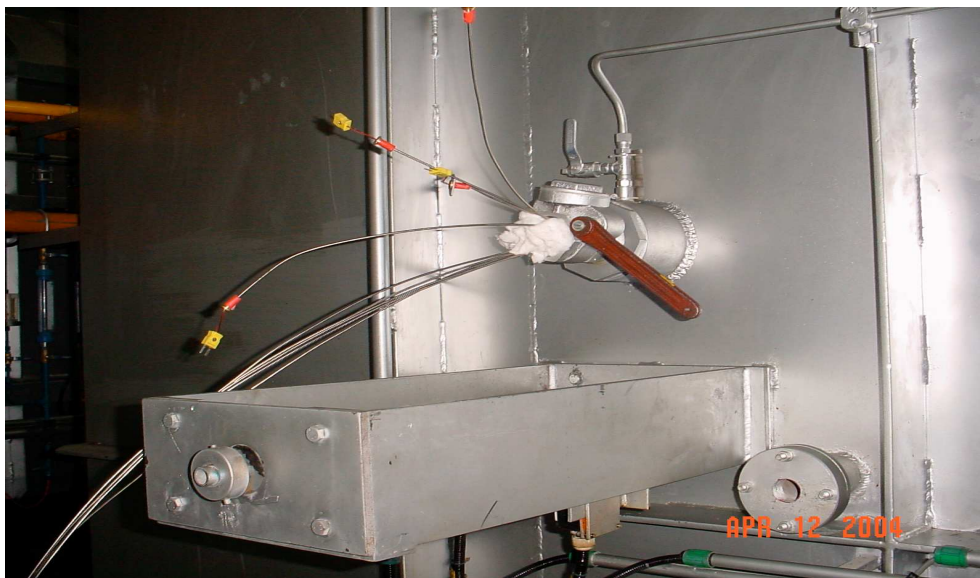
Kuva 15 Termoelementtien läpivienti uuniin /3 /
