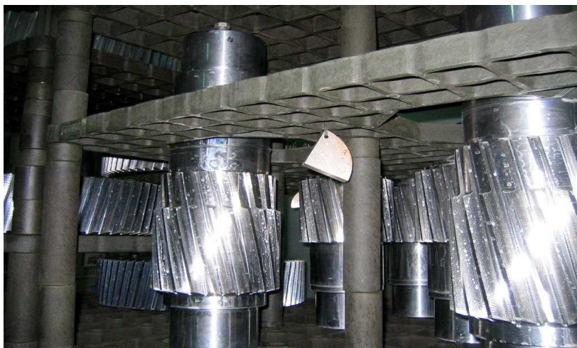
Kuva 22 Koepala sijoitettuna karkaisupanokseen /3/
