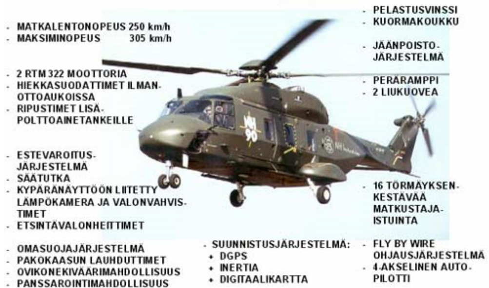
Kuva 4 NH90-Helikopterin teknisiä tietoja /9/
