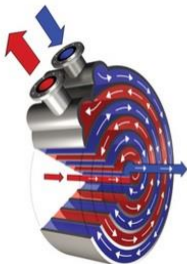
KUVA 4. Spiraalilämmönsiirtimen rakenne ja virtaussuunnat. (Alfa Laval 2015.)
