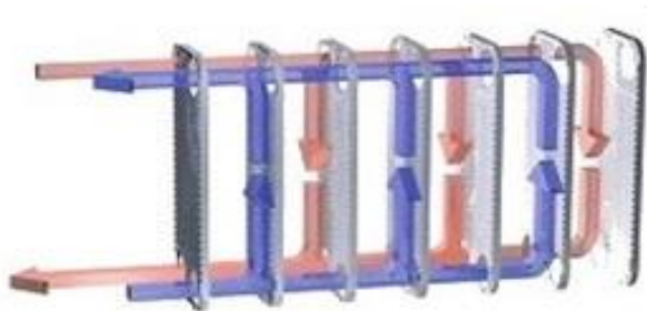
KUVA 3. Levylämmönsiirtimen rakenne ja virtaussuunnat. (Paavilainen 2012.)
