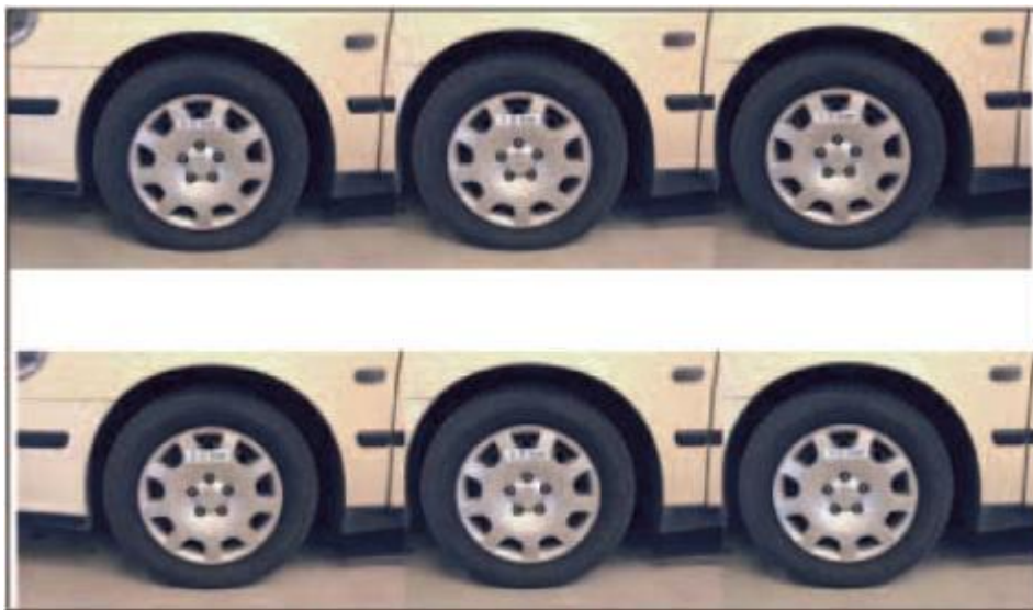
Kuva 1. Rengaspaineet ylärivissä vasemmalta oikealle 0,5–1,5 bar ja alarivissä välillä 2,0.–3,0 bar 0,5 bar:n välein [5, s. 91].
