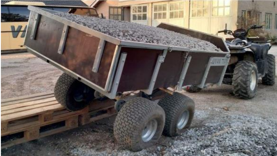
Kuva 16. Kärryn kallistuksen testaus (Lehtonen 2019: 19).
