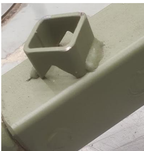
Kuva 14. Vetopään rasvanipan suojustus.
