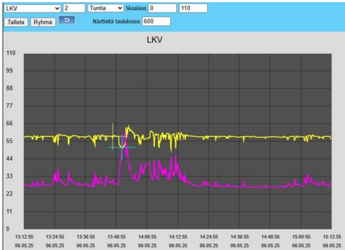
Kuva 24. Pelkälle kierrolle viritetty säätö aiheutti suuria poikkeamia kuormitustilanteessa
