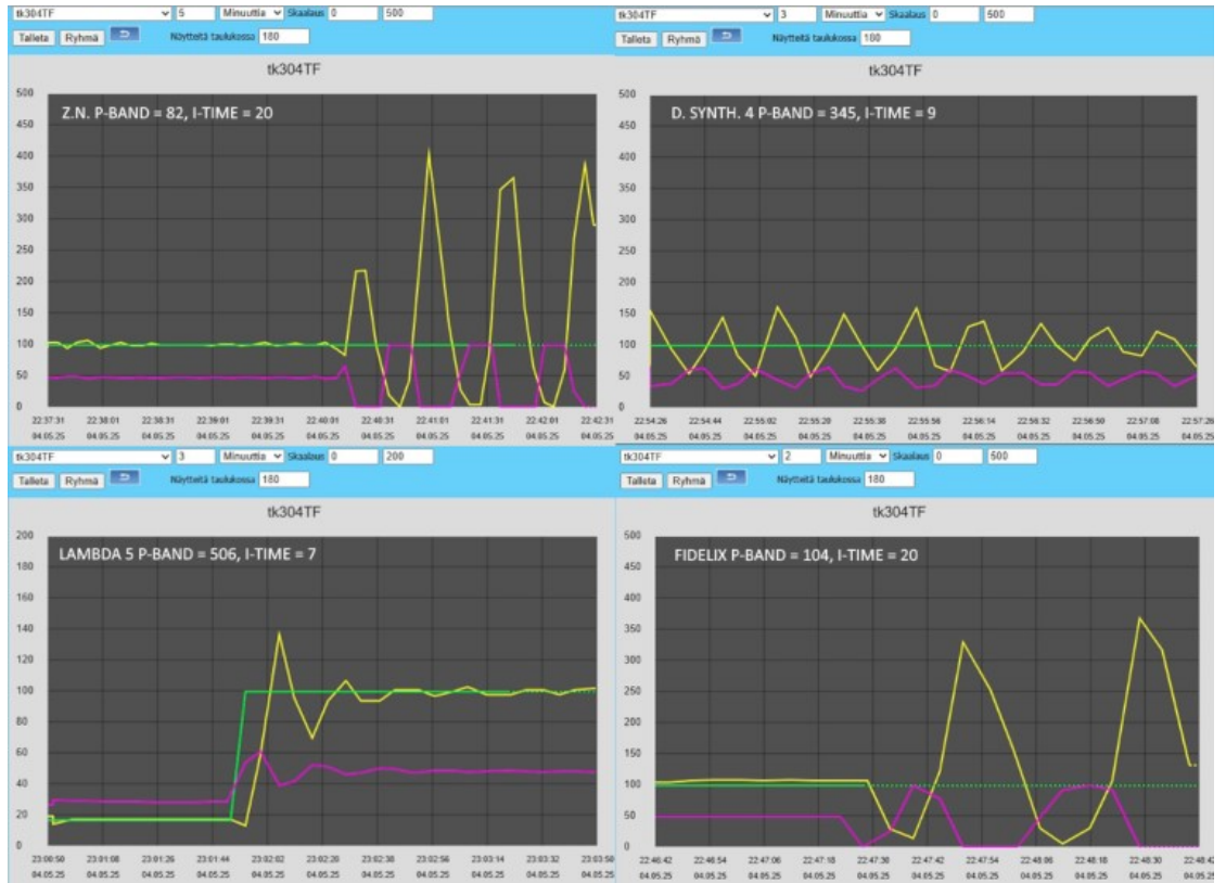
Kuva 27. Ainoastaan Lambda-virityksellä saatiin rauhallinen säätö puhaltimen molemmille asetusarvoille.
